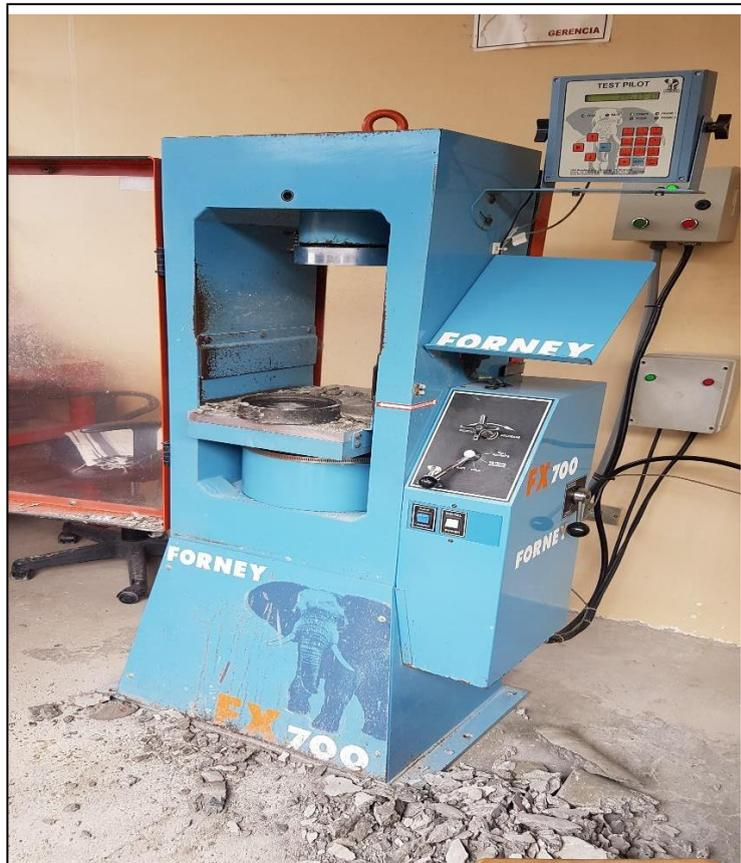
Figura 22. Máquina para rotura a la compresión simple. Elaborado por: Chóez Miranda, R (2018)
