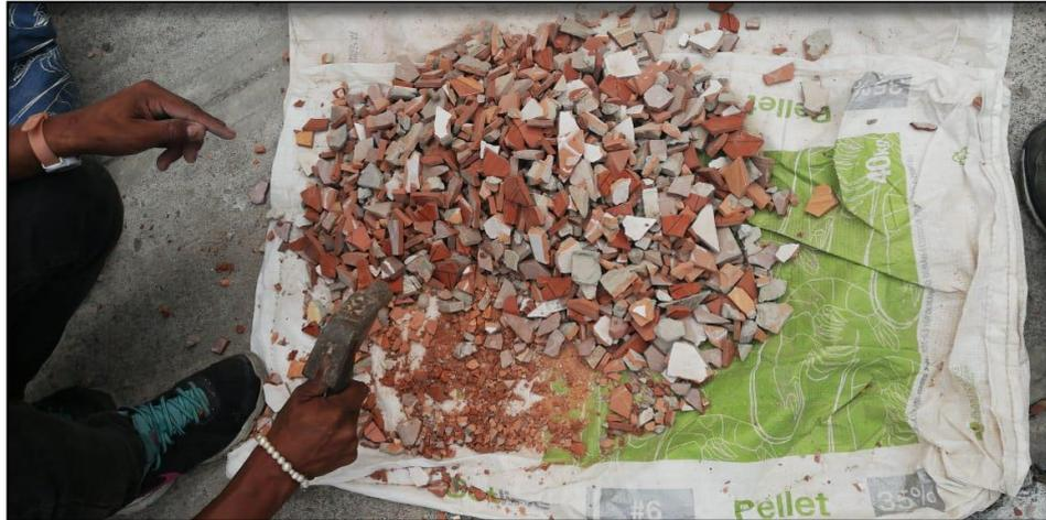
Figura 10: Triturado de material reciclado. Elaborado por: Chóez Miranda, R (2018)
