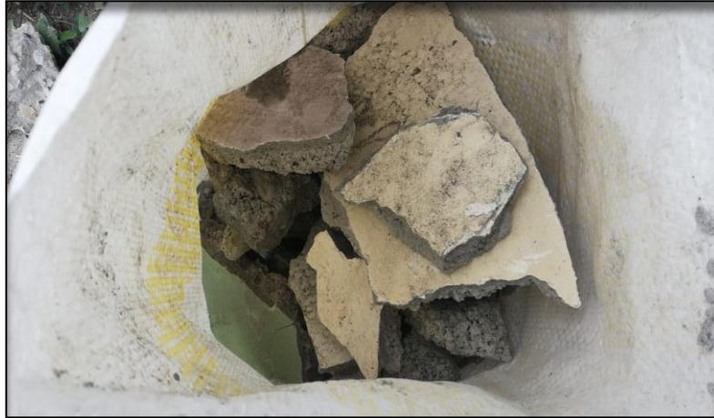
Figura 8: Material reciclado y ensacado de mampostería. Elaborado por: Chóez Miranda, R (2018)
