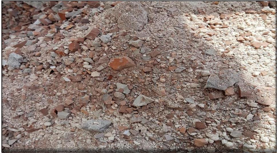
Figura 11: Materiales de residuos reciclados de cerámica y mampostería triturados. Elaborado por: Chóez Miranda, R (2018)
