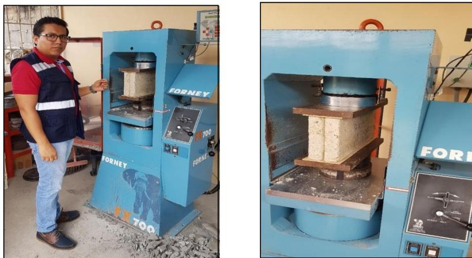
Figura 26. Ensayo de compresión simple a bloque. Elaborado por: Chóez Miranda, R (2018)
