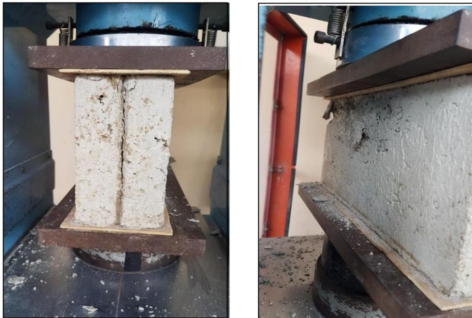
Figura 27. Rotura de bloque en compresión simple. Elaborado por: Chóez Miranda, R (2018)
