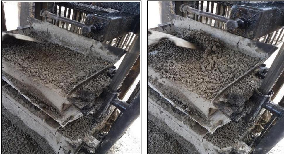
Figura 18. Vertido de mortero en maquina artesanal de fabricación de bloque. Elaborado por: Chóez Miranda, R (2018)
