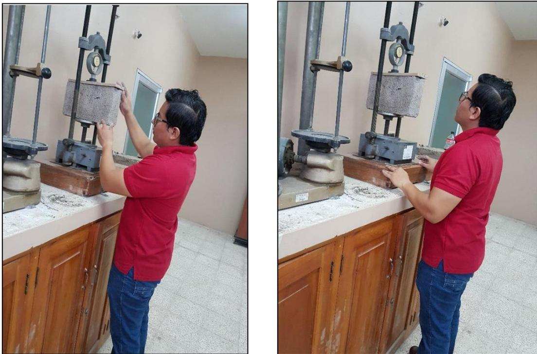
Figura 24. Ensayo de compresión simple a bloque. Elaborado por: Chóez Miranda, R (2018)
