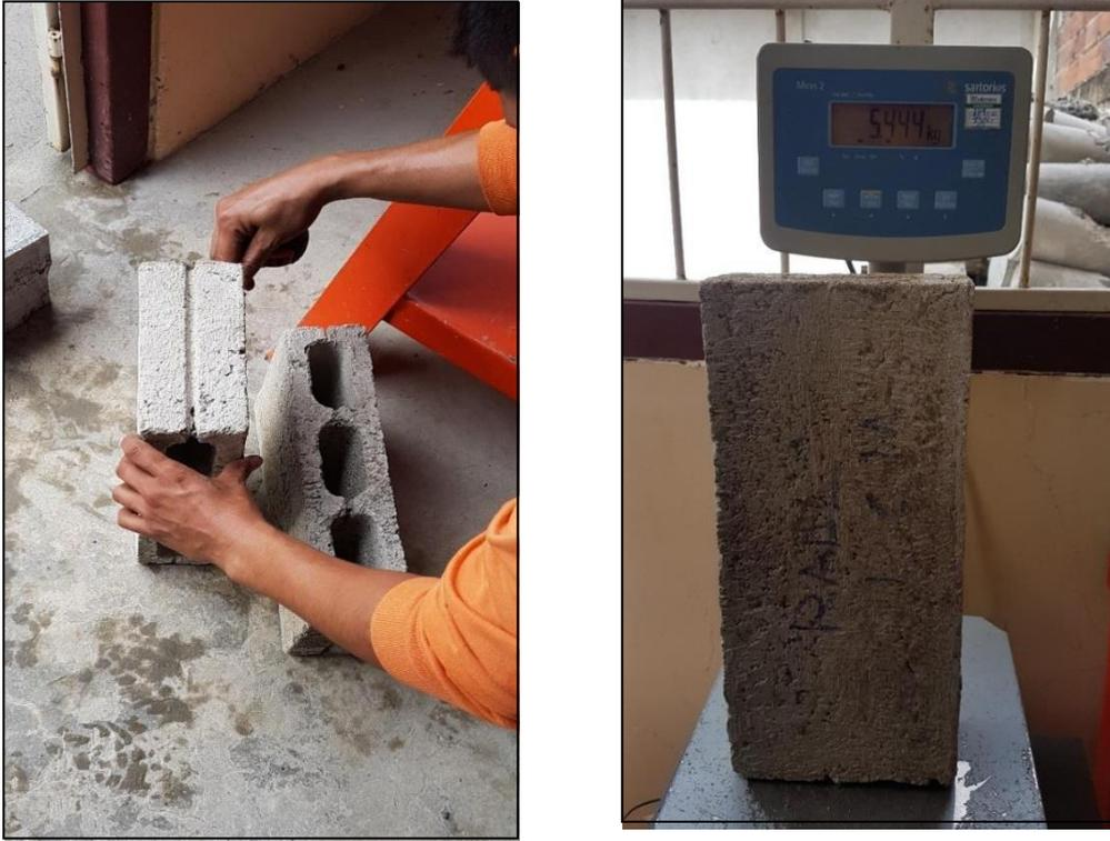
Figura 23. Procesos de medición y peso a bloque. Elaborado por: Chóez Miranda, R (2018)
