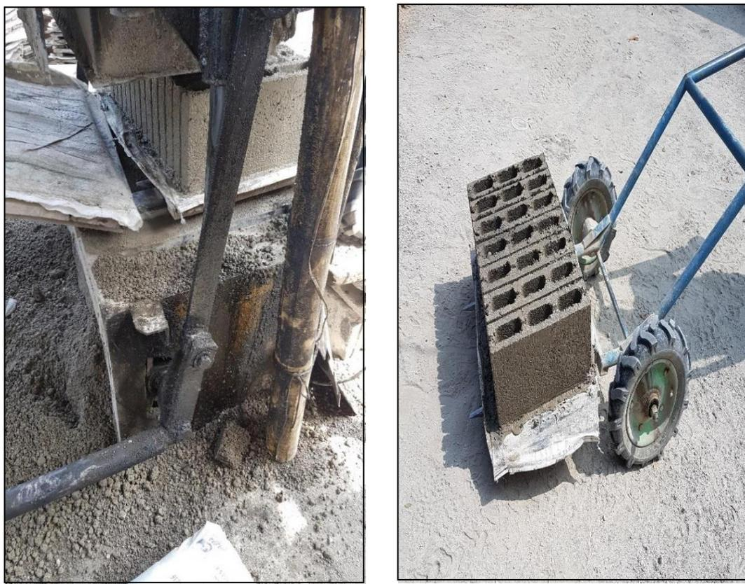
Figura 20.Retiro de los bloques de la maquina
