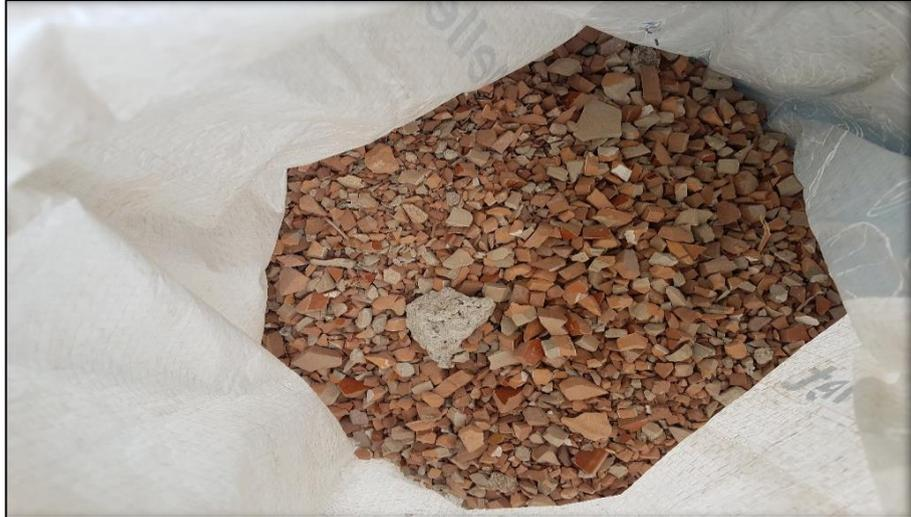
Figura 7: Material reciclado triturado y ensacado de cerámica. Elaborado por: Chóez Miranda, R (2018)
