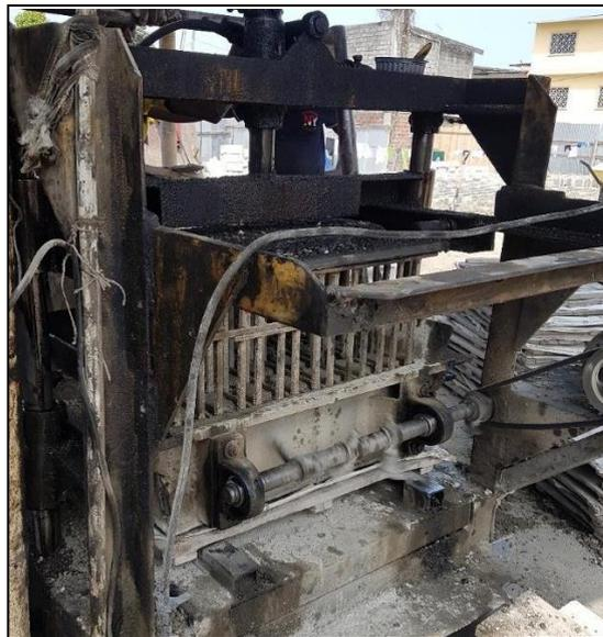
Figura 17. Máquina artesanal de fabricar bloques
