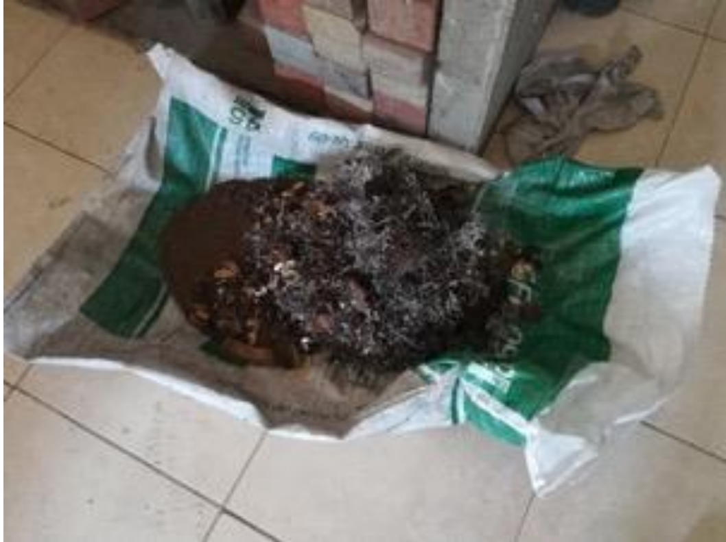
Imagen 14. Tamizado de desperdicios de aceros
