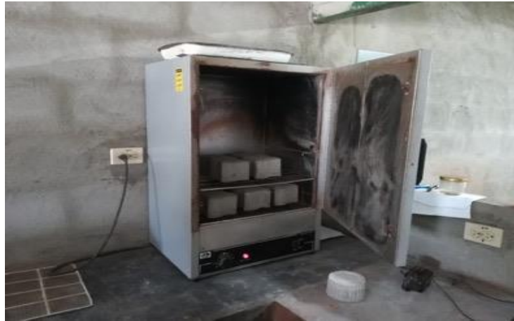
Imagen 22. Horno – prueba de humedad y absorción Elaboración: Luis Daniel Hurtado Cevallos & Kevin Astolfo Pincay Nieto, (2018)
