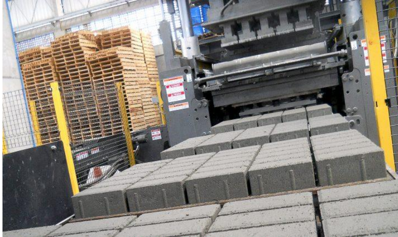
Imagen 28. Salida en línea de la maquina vibro-compactadora – Prototipo 1 Elaboración: Luis Daniel Hurtado Cevallos & Kevin Astolfo Pincay Nieto, (2018)
