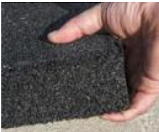
Imagen 6. Pavimento de Caucho2 Fuente: EcoNaturals, (2014)
