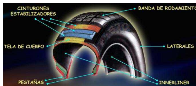
Figura 37. Componentes y funciones del neumático Fuente: Castro Guillermo - 2014
