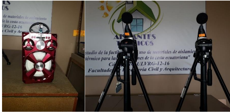
Imagen 20. Equipos para pruebas acústicas Elaboración: Iñiga Balón, C. –Ledesma Salazar, G. (2018)
