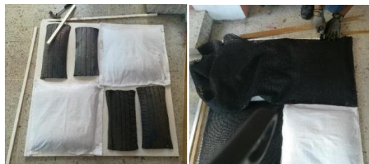
Imagen 6. Colocación de polipropileno Elaboración: Iñiga Balón, C. –Ledesma Salazar, G. (2018)
