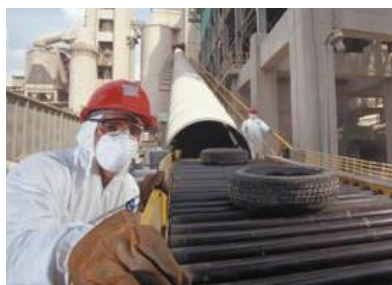
Figura 13. Horno cementero para combustión de neumáticos Fuente: QuimiNet, 2018
