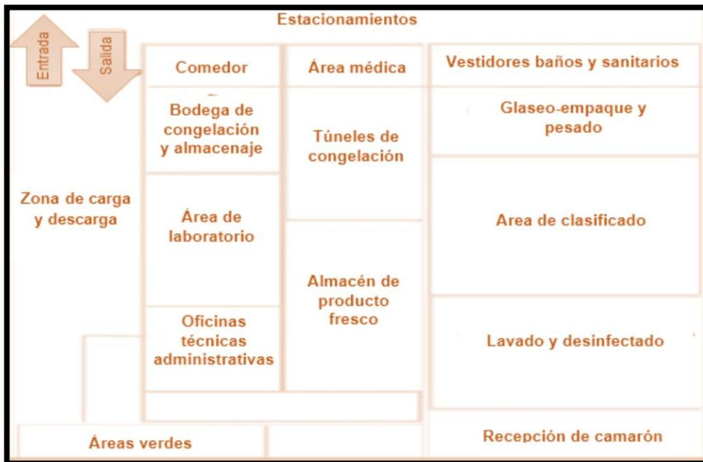
**Figura 5.** Instalación física de la empacadora de colas de camarón
