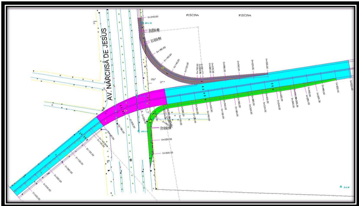
Figura 10 Solución a desnivel en la intersección de la av. Narcisa de Jesús y la vía de acceso al puente. Fuente: Asociación Puente GUASAMDA
