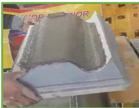
*Ilustración 83:* Curado en molde con fibra triturada y lavada.
