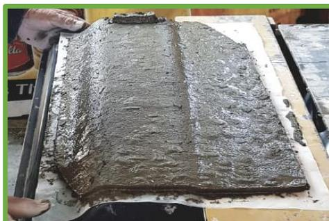
**Ilustración 74:** Curado en molde con fibra molida.
