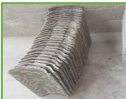
*Ilustración 64:* Tejas fabricadas con adición de fibra.
