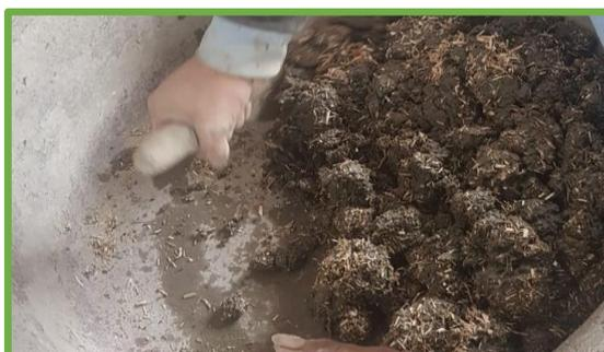
*Ilustración 82:* Mortero con fibra triturada y lavada.
