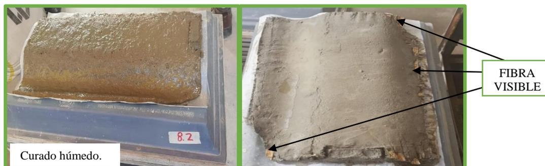
**Ilustración 68:** Teja terminada con fibra tipo malla.
