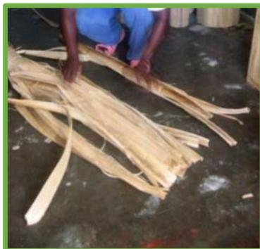
*Ilustración 28:* Extracción de la Fibra de Banano.
