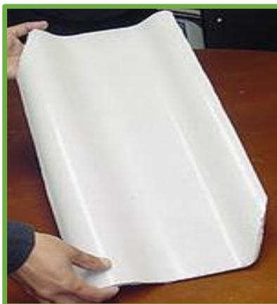
*Ilustración 44:* Teja micro concreto.
