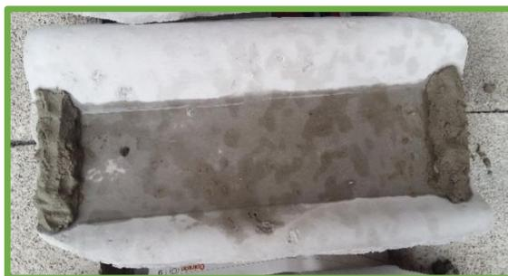
*Ilustración 81:* Ensayo de permeabilidad con fibra triturada.
