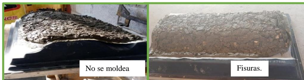
**Ilustración 65:** Proceso de elaboración con fibra gruesa.
