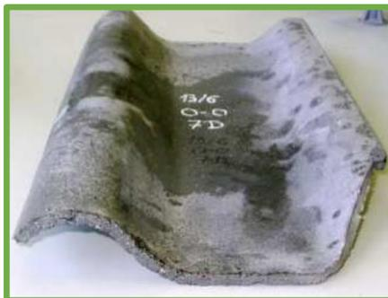
**Ilustración 2:** Teja fabricada.
