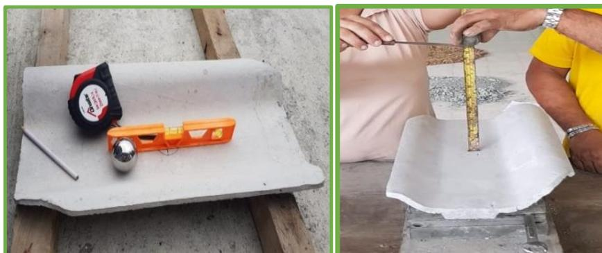
*Ilustración 88:* Ensayo de Impacto con fibra triturada y picada.
