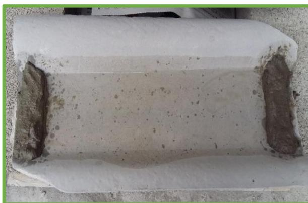
**Ilustración 87:** Ensayo de Permeabilidad con fibra triturada y lavada.
