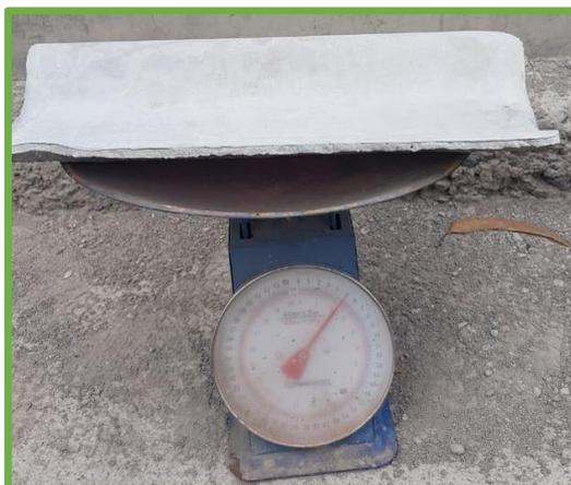
**Ilustración 86:** Ensayo de peso con fibra triturada y lavada.
