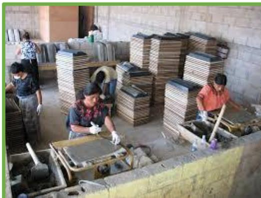
*Ilustración 52:* Curado Primario.
