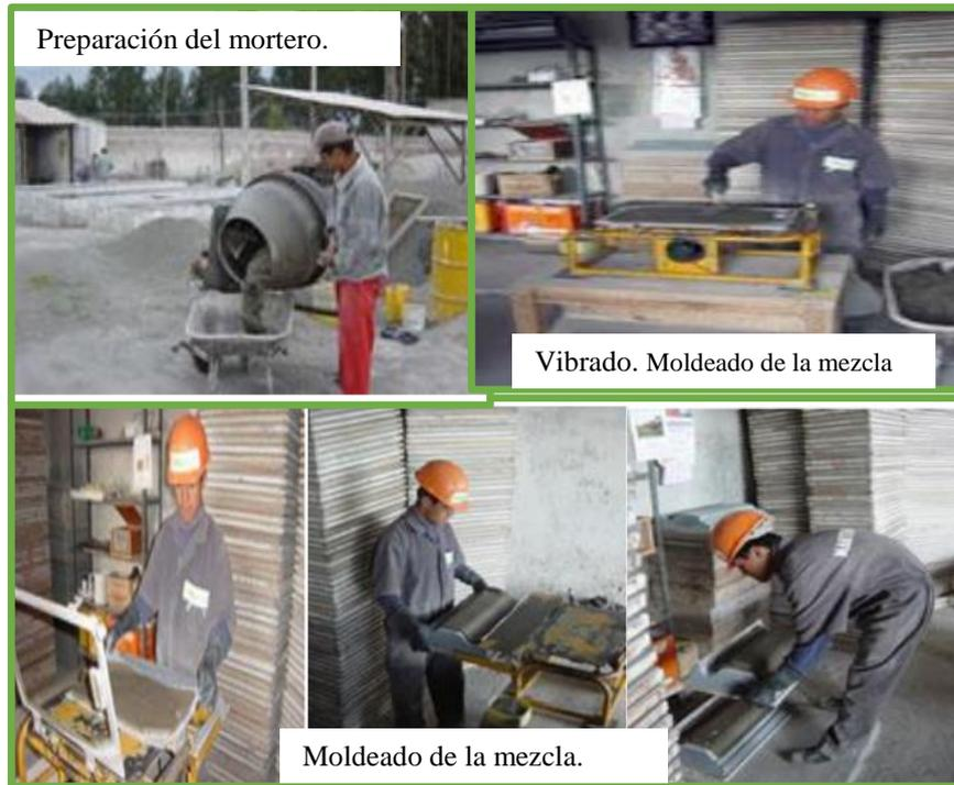
**Ilustración 37:** Proceso de elaboración de una teja.
