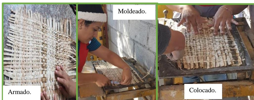
**Ilustración 67:** Proceso de elaboración con fibra tipo malla.
