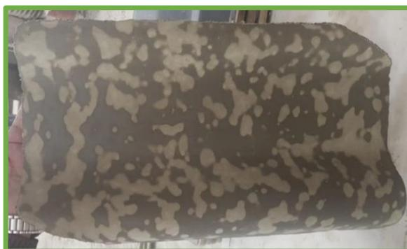
*Ilustración 79:* Curado húmedo con fibra triturada.
