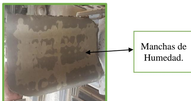
*Ilustración 75:* Curado húmedo con fibra molida.
