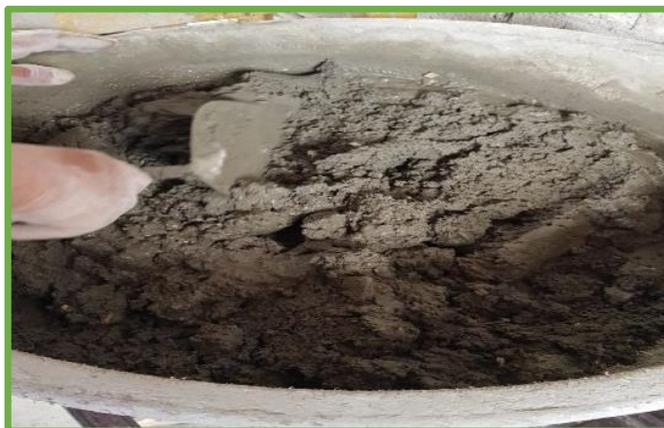
*Ilustración 70:* Mortero con fibra picada.
