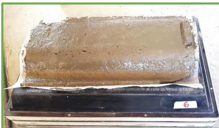
*Ilustración 71:* Curado en molde con fibra picada.
