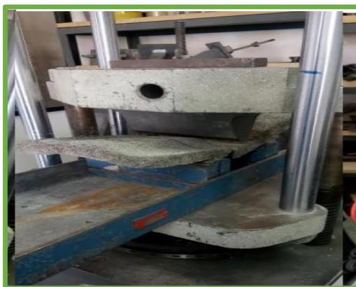
*Ilustración 57:* Ensayo de Resistencia a la Flexión.
