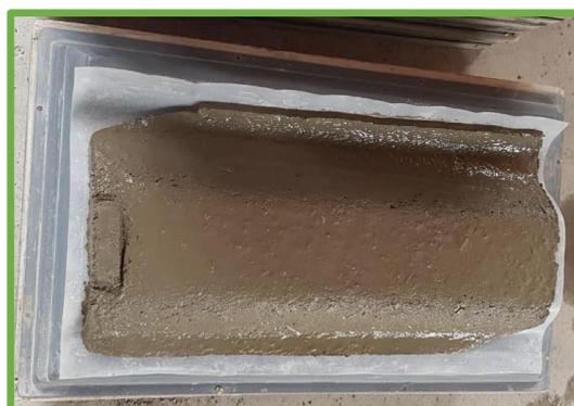
*Ilustración 78:* Curado en molde con fibra triturada.
