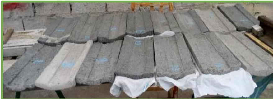
**Ilustración 1:** Tejas Elaboradas con Caucho Reciclado.
