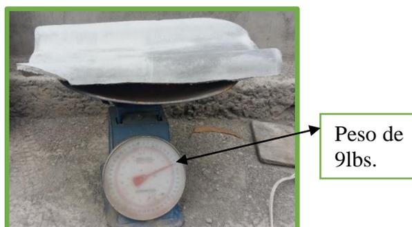
*Ilustración 77:* Peso de la teja con fibra molida.
