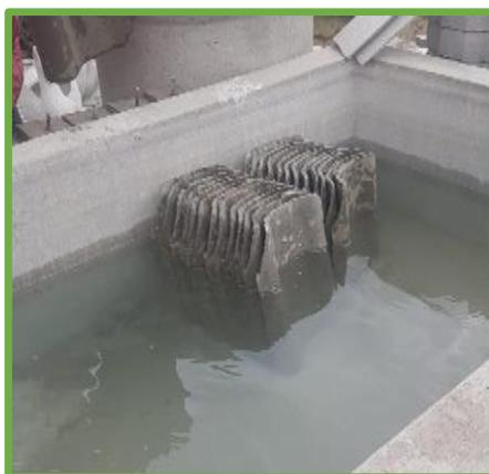
*Ilustración 84:* Curado húmedo con fibra triturada y lavada.
