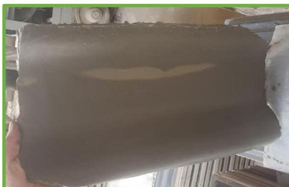
**Ilustración 72:** Curado húmedo con fibra picada.
