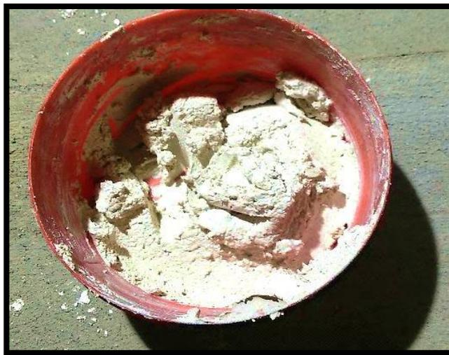
*Figura 63. Mezclas de empaste terminado con aditivo de cuero de vaca y blancola.
