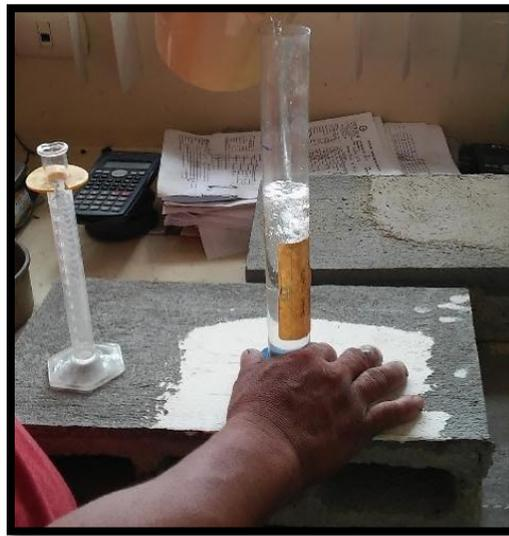
**Figura 65. Permeabilidad de la superficie (absorción del agua) sobre el sustrato.**
