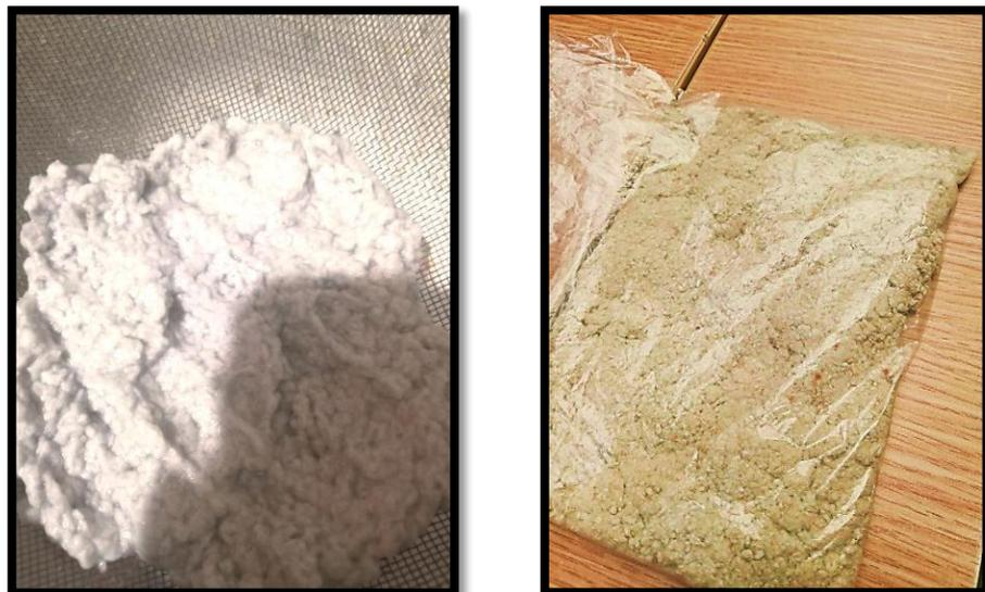
*Figura 56. Secado de muestra de empaste con papel, cartón y resina poliéster.
