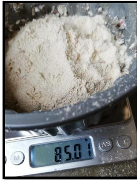
*Figura 58. Pesado de mezcla de empaste con cal y yeso.
