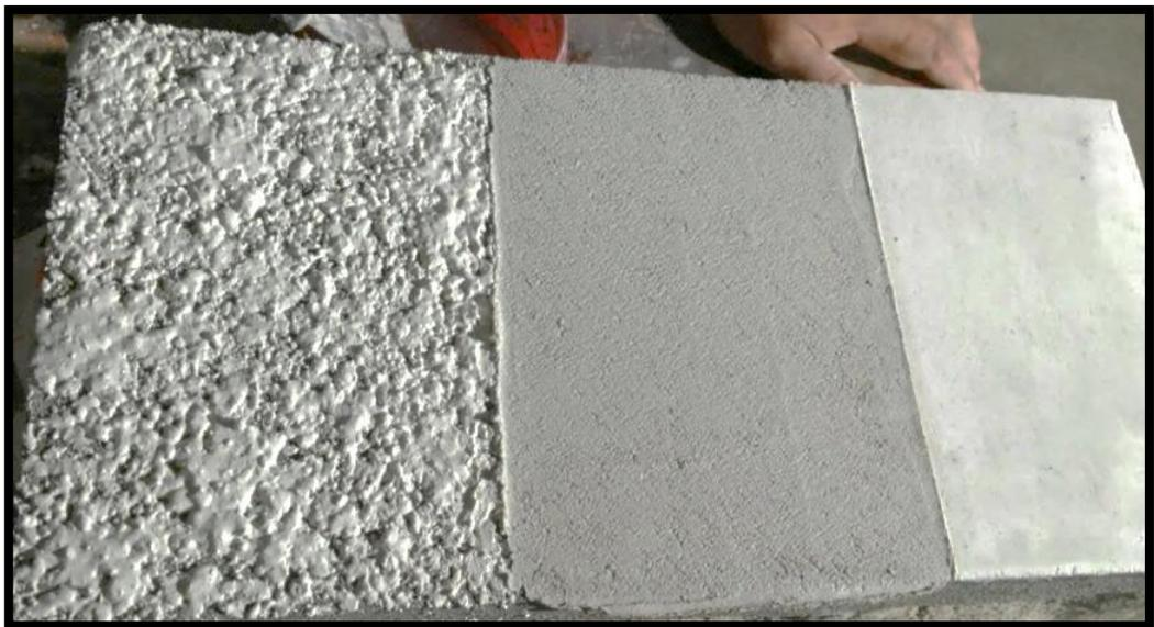
**Figura 70. Resultado final del empaste sobre superficie.**
