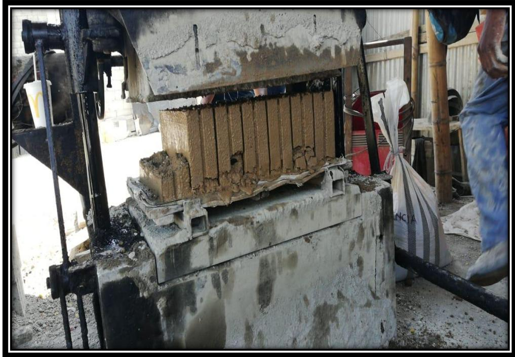
Ilustración 18 Salida del prototipo de bloque muestra 2
