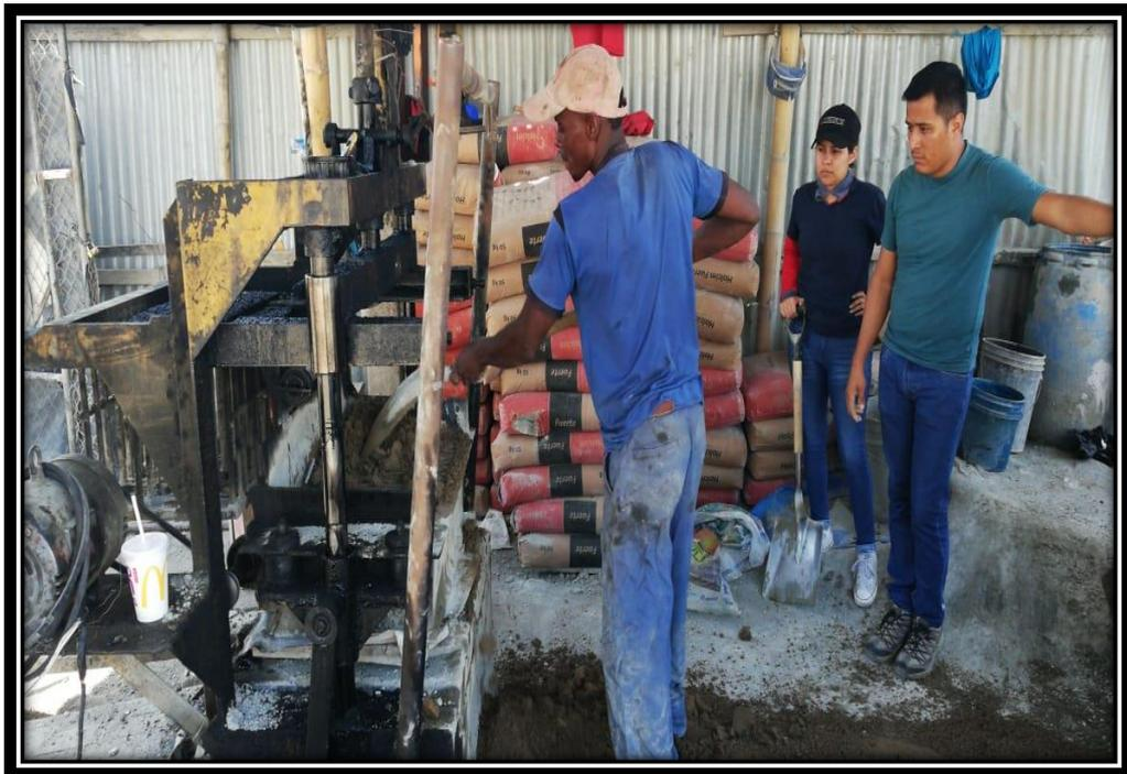
Ilustración 13 Llenado con la mezcla en la bloquera
