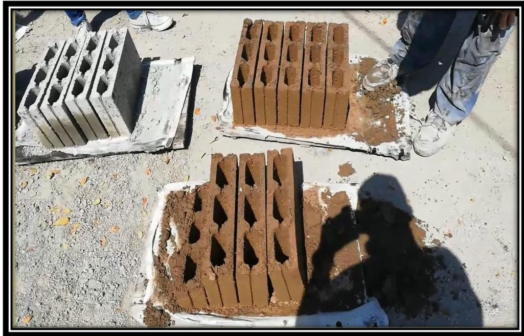
Ilustración 24 Secado de los prototipos de bloques, muestra 1, muestra 2, muestra 3. Después de una hora
