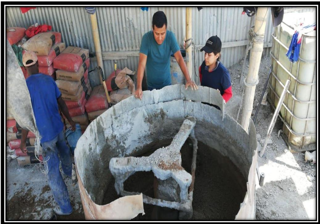
Ilustración 11 Máquina mezcladora en proceso centrifugo
