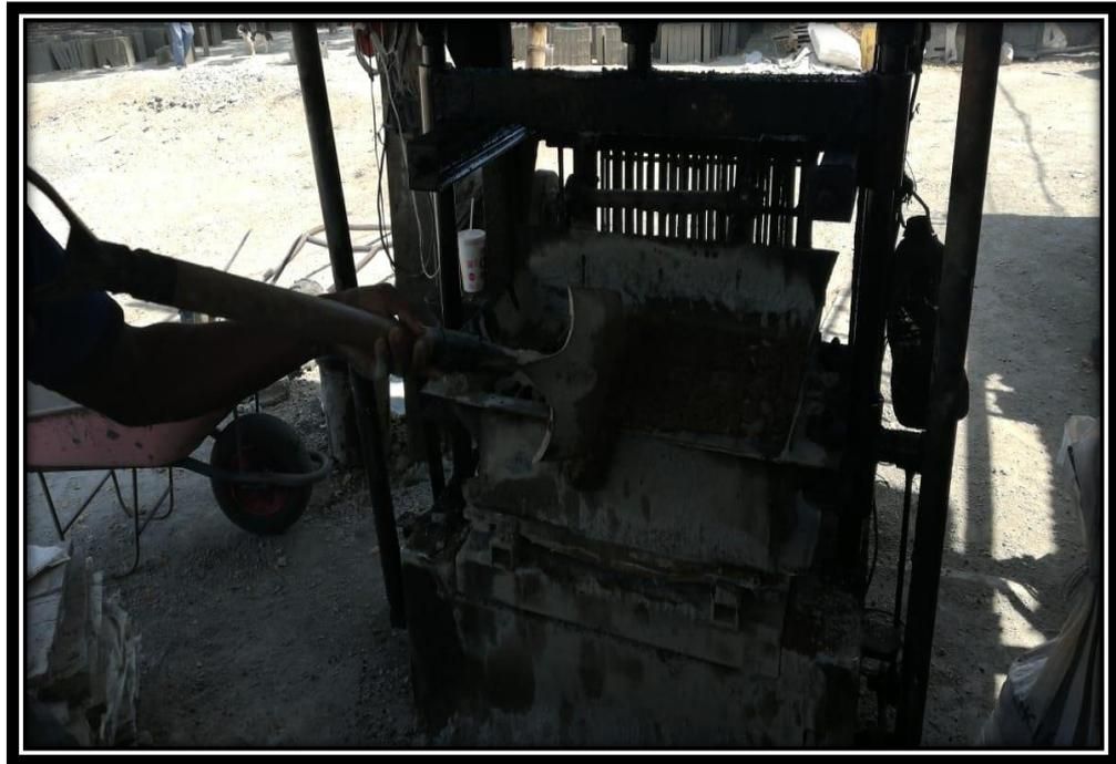
Ilustración 14 Bloquera en proceso de elaboración del bloque
