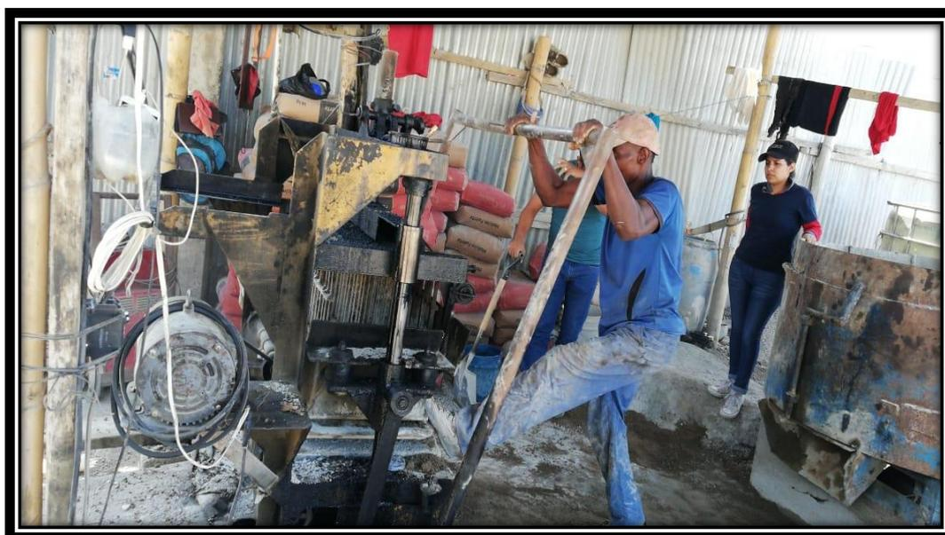
Ilustración 22 Procedimiento de ajuste en la elaboración del bloque
