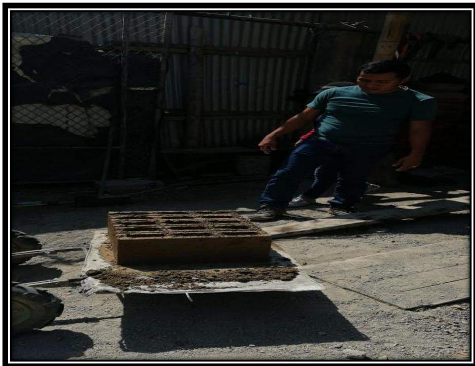
Ilustración 20 Muestra expuesta al secado natural
