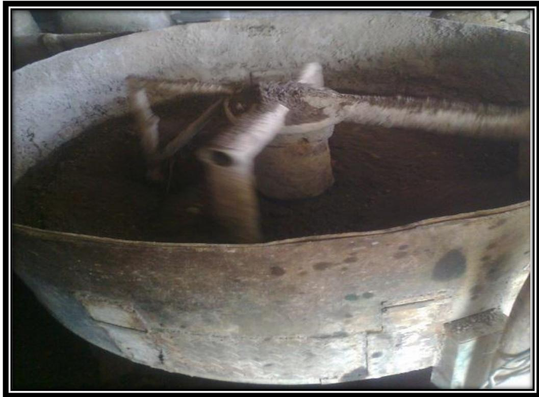
Ilustración 4 Máquina mezcladora de agregados para la elaboración de bloques
