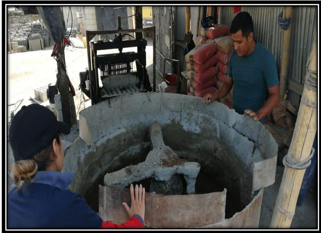
Ilustración 12 Mezcladora en proceso centrífugo
