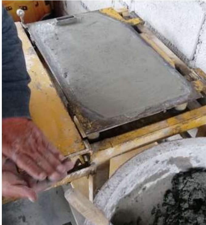
Figura 50. Vibración de la teja en el mortero. Fuente: Méndez Vulgarin, Jesy Elaborado por: Méndez Vulgarin, Jesy
