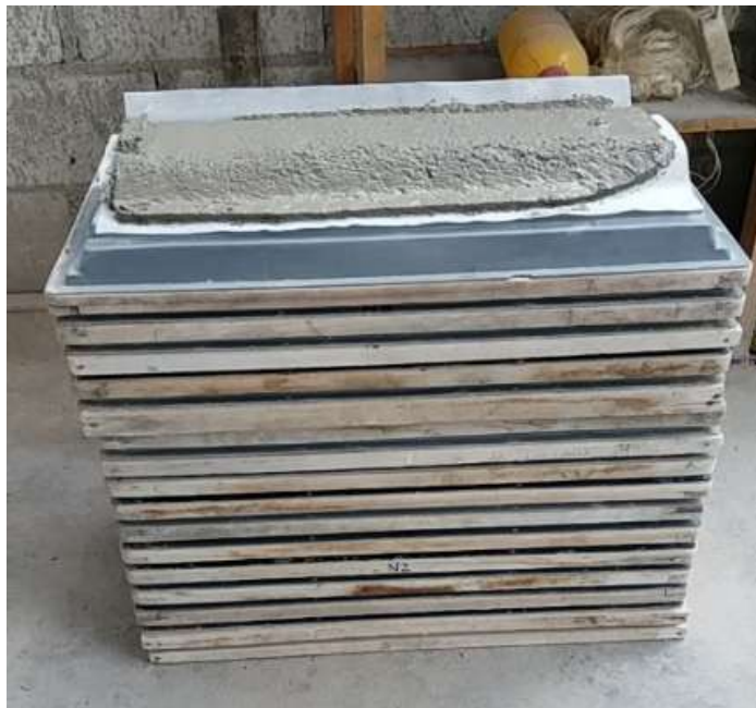
Figura 51. Curado por 24 horas en los moldes. Fuente: Méndez Vulgarin, Jesy Elaborado por: Méndez Vulgarin, Jesy
