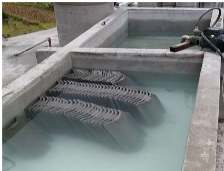
Figura 53. Curado de las tejas a la tina por 7 días. Fuente: Méndez Vulgarin, Jesy Elaborado por: Méndez Vulgarin, Jesy
