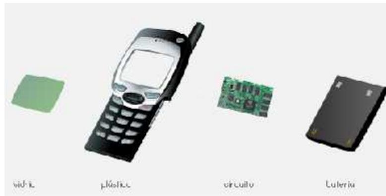
La parte más constante del negocio es aquí, donde se desmantelara el dispositivo como muestra la gráfica para ejemplo, se desmantelara un celular del cual obtendremos vidrio, plástico, circuito, batería
