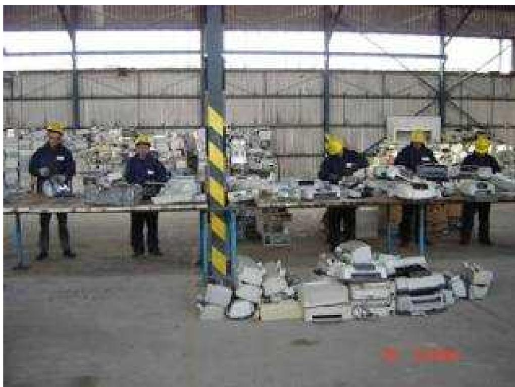
**Ilustración 8 Desmontaje manual y separación de componentes peligrosos**
