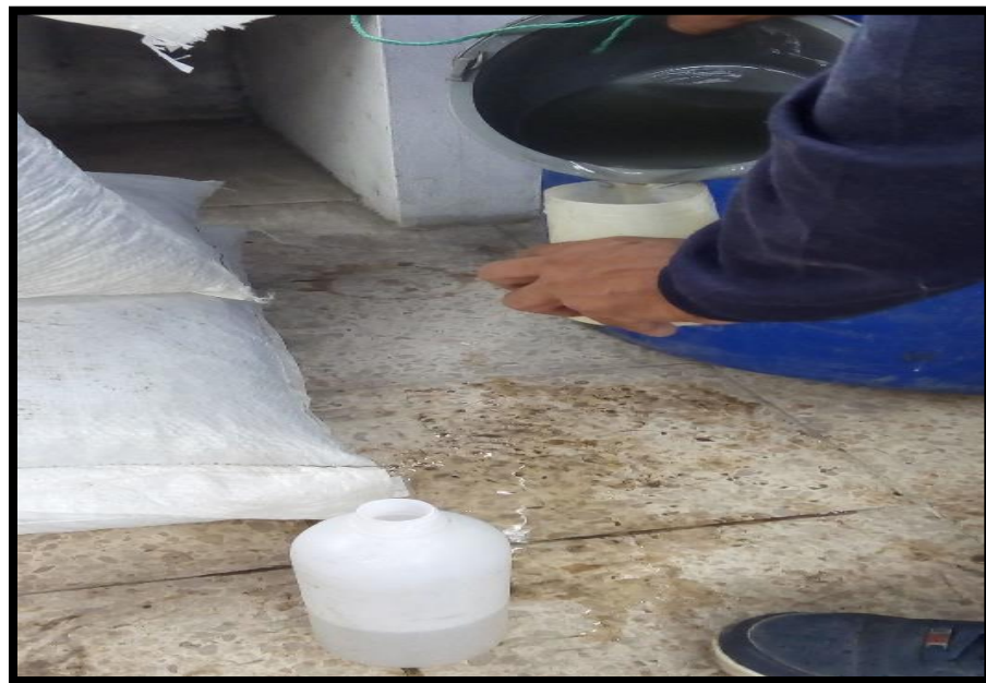
Ilustración 15 Toma de Primera muestra de Salida de Agua Residual Fuente: (Los Autores, 2018)
