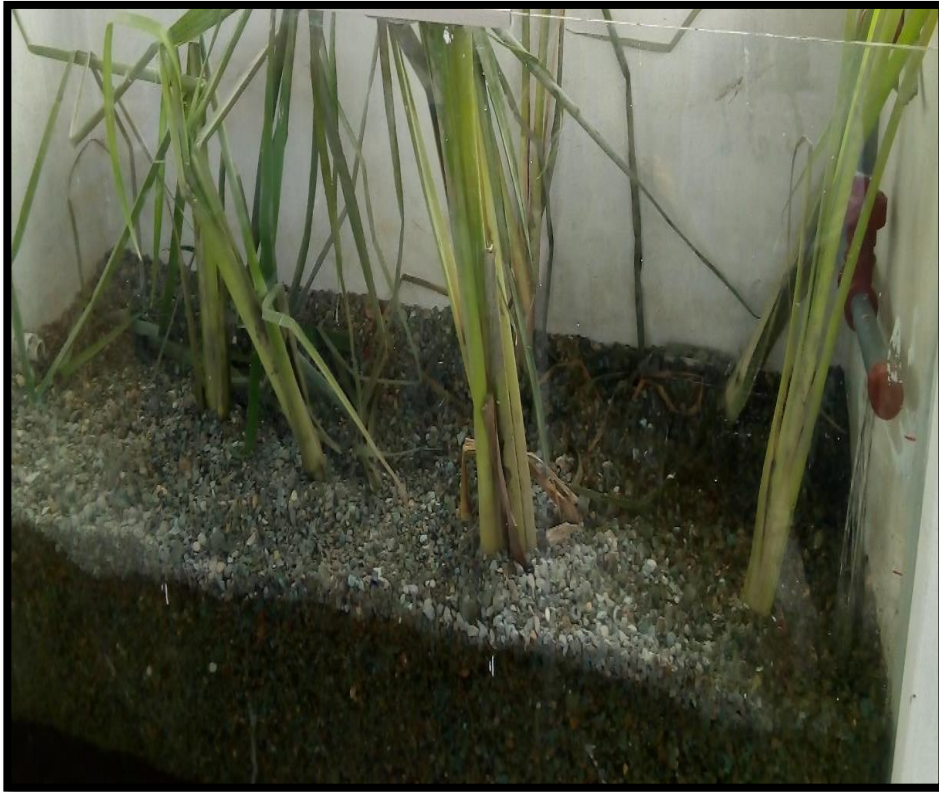
Ilustración 16 Colocación primera capa de zeolita
