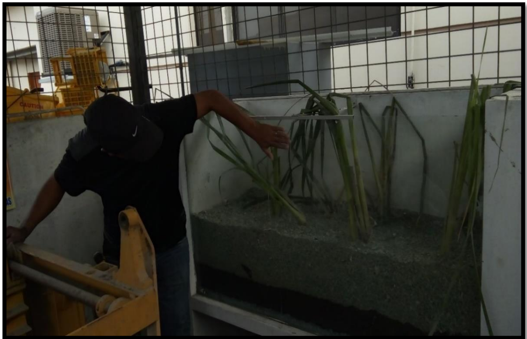
Ilustración 8 Material Colocado en el Humedal Artificial
