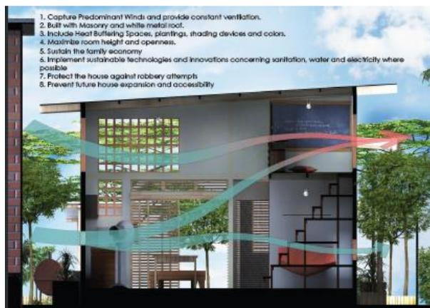
**Figura 18:** Ilustración, Presión del aire por ventilación cruzada,
