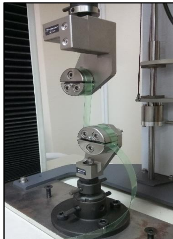
Anexo 10. Ensayo de tensión en cinta PET. Fuente. Laboratorio de Ensayos Metrológicos y de Materiales LEMAT – ESPOL.
