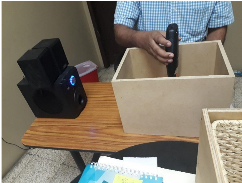
Caja MDF sin recubrimiento para prueba acústica
