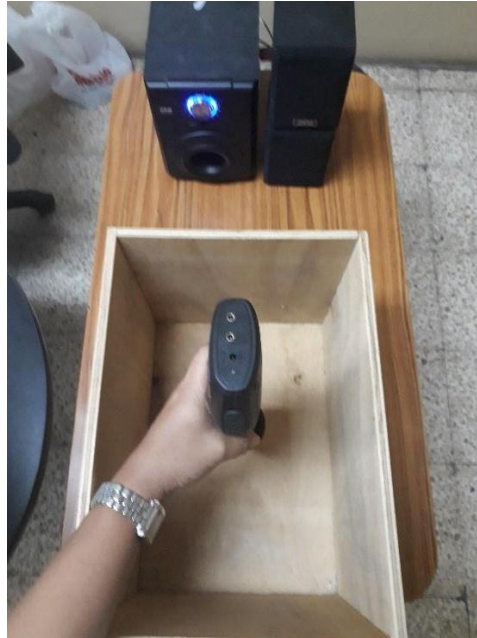
Prueba acústica en caja de plywood sin recubrimiento
