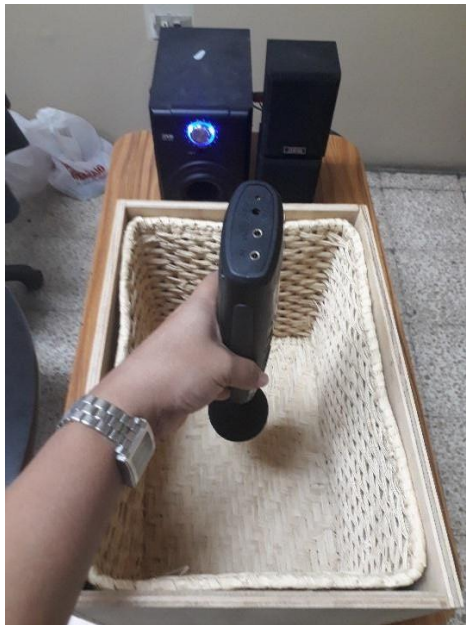
Prueba acústica en caja de plywood con recubrimiento.
