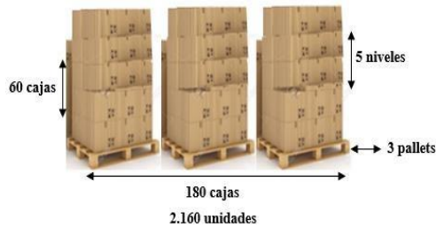
Figura 38. Paletización con cajas de la salsa de cacao. Elaborado: Barzallo Muñoz, M; Gomez Pin, D (2018).
