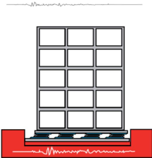
*Figura 10 - Edificio CON aisladores sísmicos*
