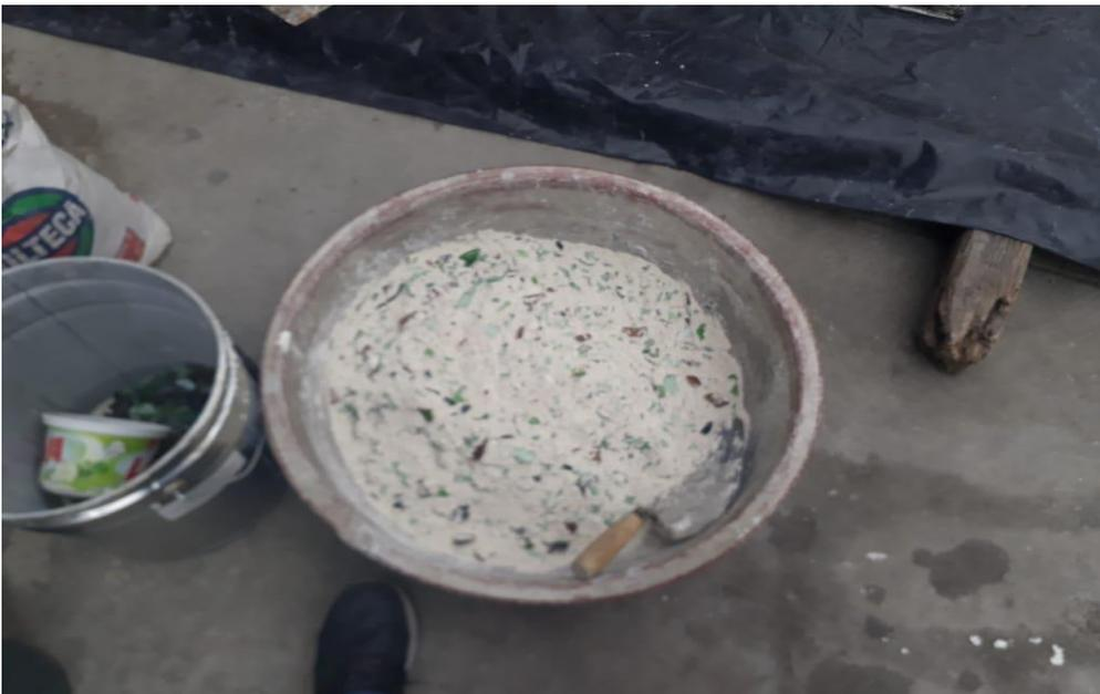
*Ilustración 27* Mezcla hormigón que incluye vidrio reciclado
