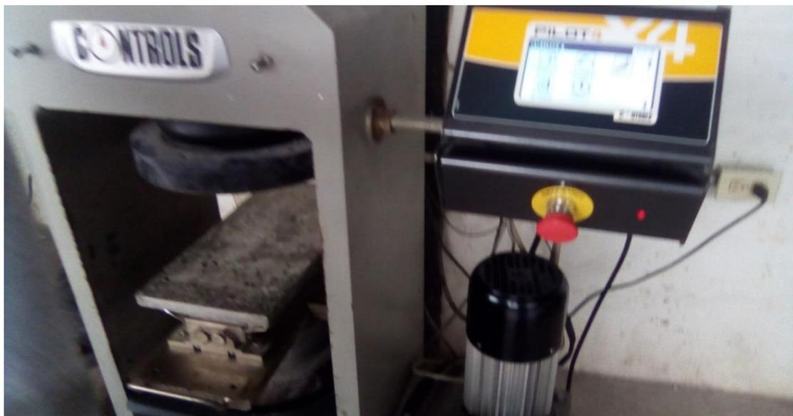
Ilustración 20 Realización de ensayo de resistencia a la flexión
