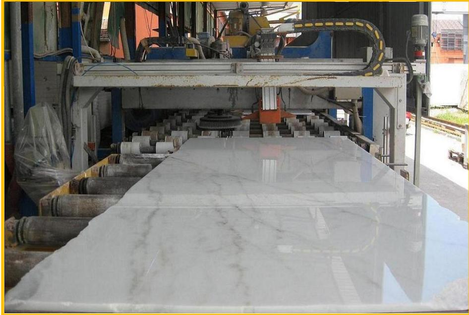
*Ilustración 6. Corte y pulido de placas de mármol.
