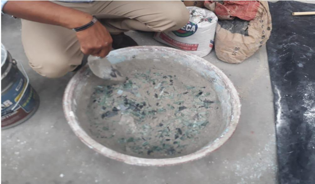
*Ilustración 26* Mezcla hormigón que incluye vidrio reciclado.
