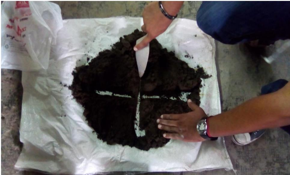
*Ilustración 24* Técnica de cuarteo para selección de la muestra.
