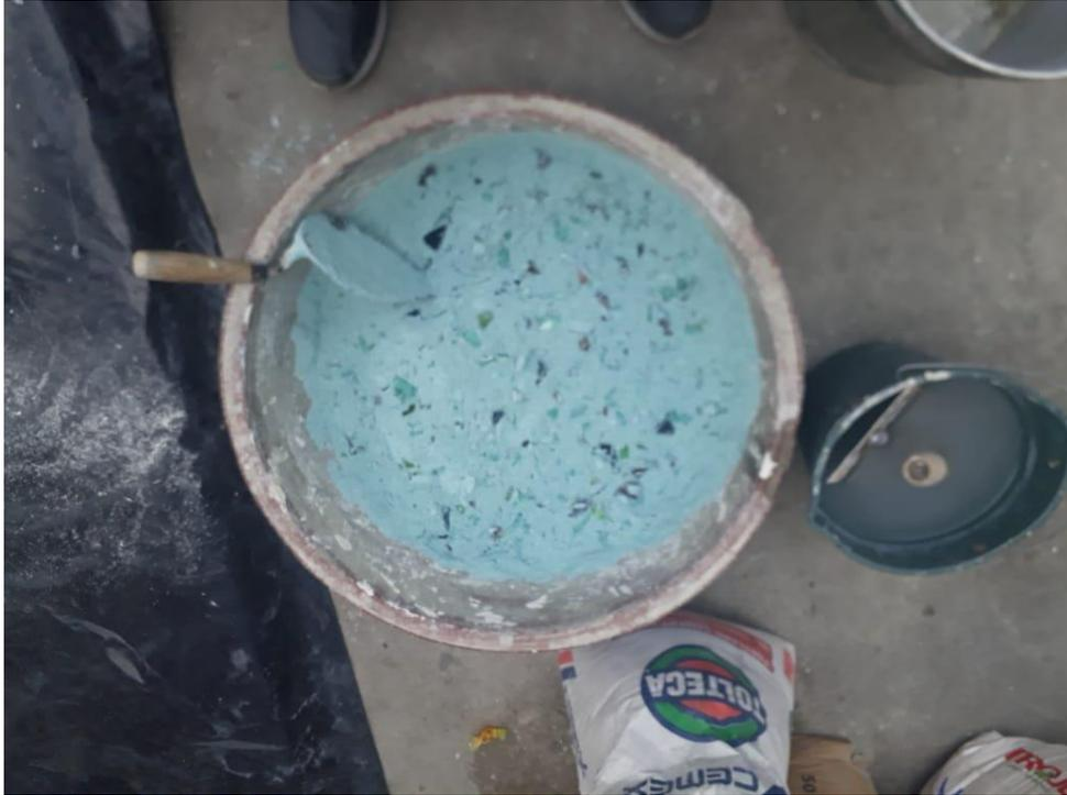
*Ilustración 28* Mezcla hormigón que incluye vidrio reciclado.
