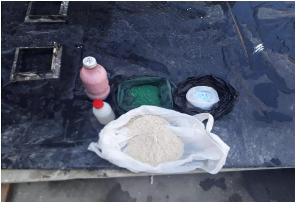
*Ilustración 29* Resinas para dar color al hormigón.
