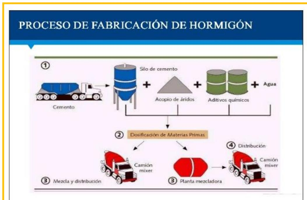
Ilustración 17 .Proceso de Fabricación del Hormigón.
