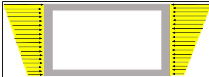
**Figura 28.** Carga viva sobre los muros
