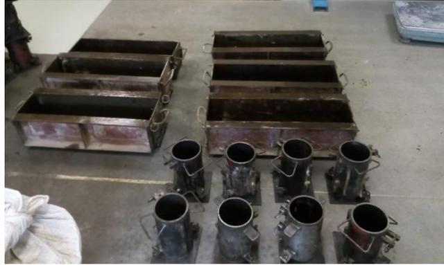
**Gráfico 16 moldes para fundir los elementos estructurales.**
