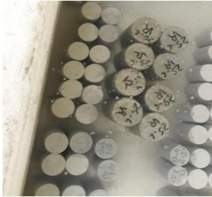
**Gráfico 20 Curado de cilindros para ensayo de compresión simple.**
