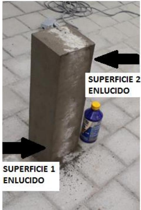
**Gráfico 14 Vista de superficie utilizadas para aplicación de mortero.**
