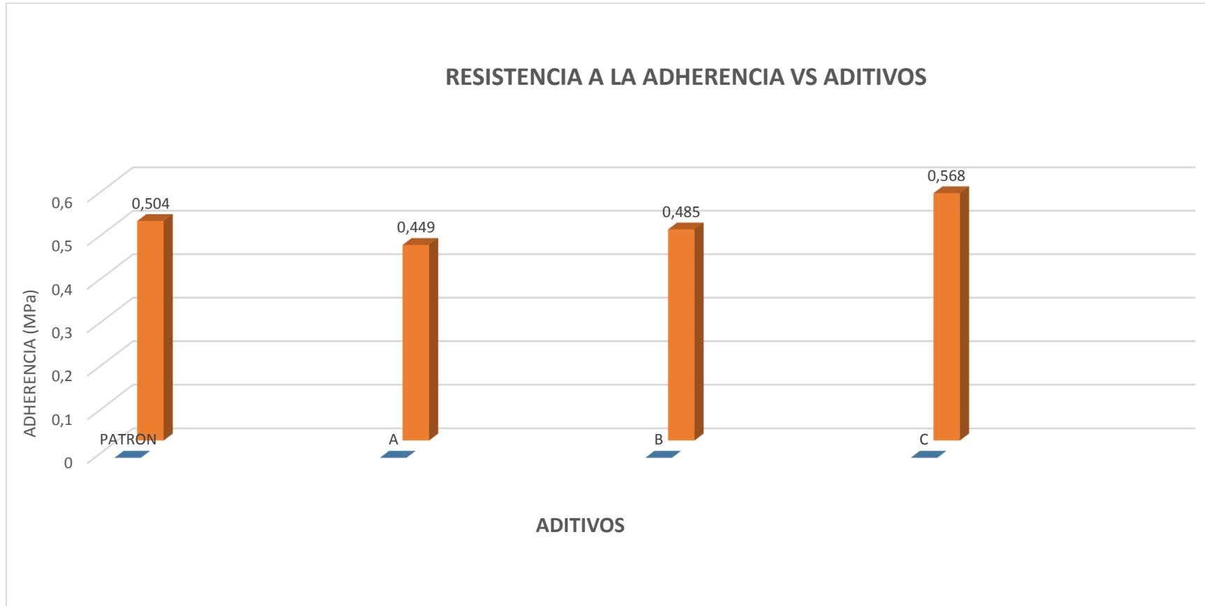
**Gráfico 433 Cuadro Comparativo de los ensayos de Resistencia a la Adherencia del Mortero en Mortero de 20 Días de Vida en Vigas de 7 Días de Fundición.**
