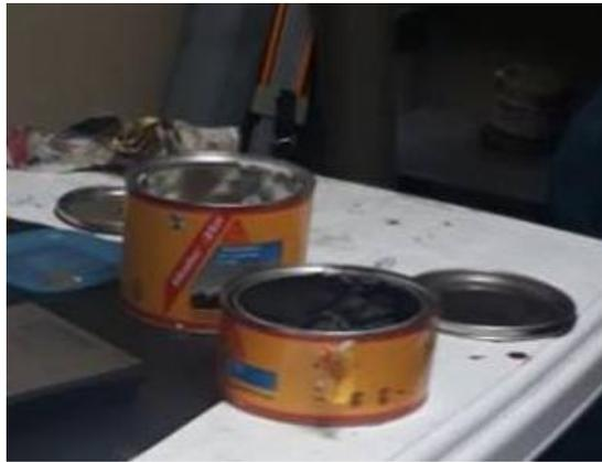
**Gráfico 37 Resina epòxica para pegado de pastillas en elementos estructurales.**
