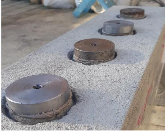
**Gráfico 36 Pastillas pegadas sobre la superficie de los Elementos de prueba.**
