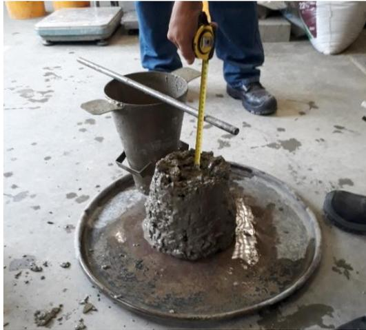
**Gráfico 18 Ensayo de revenimiento según norma ASTM C 143.**
