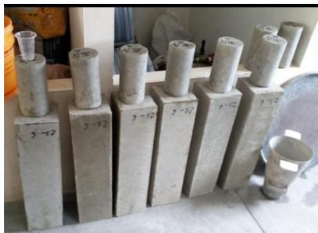
**Gráfico 22 Elementos de Hormigón para ensayos**
