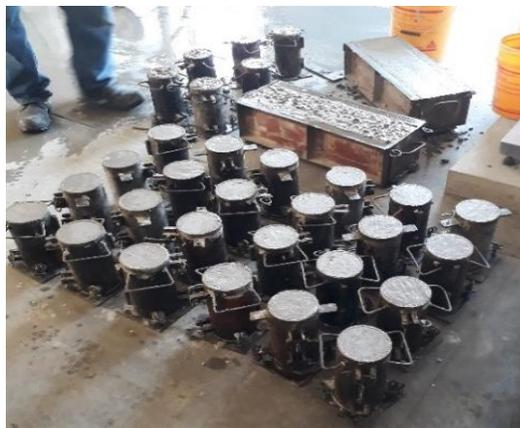
**Gráfico 19 llenado de probetas y vigas.**
