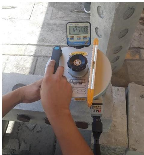
**Gráfico 39 Realización del Ensayo Pull Off.**
