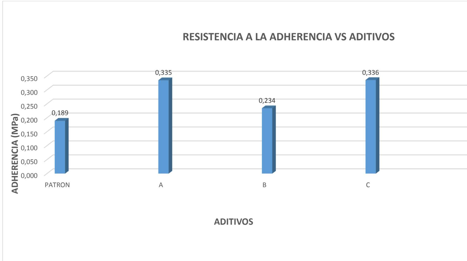
**Gráfico 411 Cuadro Comparativo Entre el Ensayo de Resistencia a la Adherencia del Mortero en Mortero de 3 Días de Vida en Vigas de 14 Días de Fundición.**
