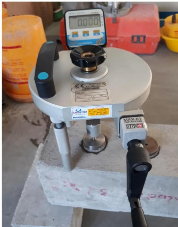
**Gráfico 17 Equipo de adherencia a tracci3n digital “Pull-Off”.**
