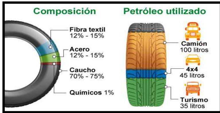
Figura 17. Componentes químicos de las llantas Fuente: Tratamiento de neumáticos usados 2018 Elaboración: Robinson Veliz, Zulay
