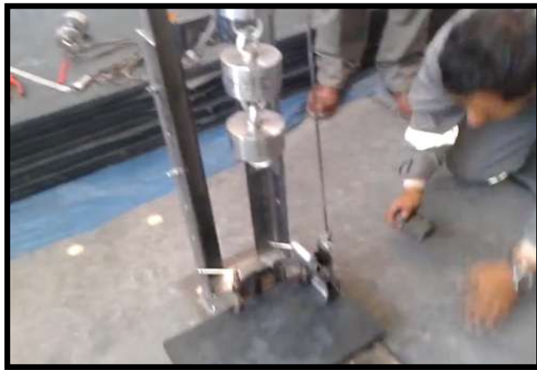
Figura 88. Determinación de tensión de una muestra de caucho reciclado
