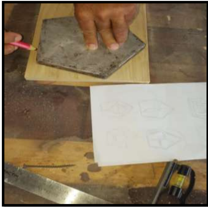
Figura 82. Molde en madera para poder obtener los moldes en hierro fundido
