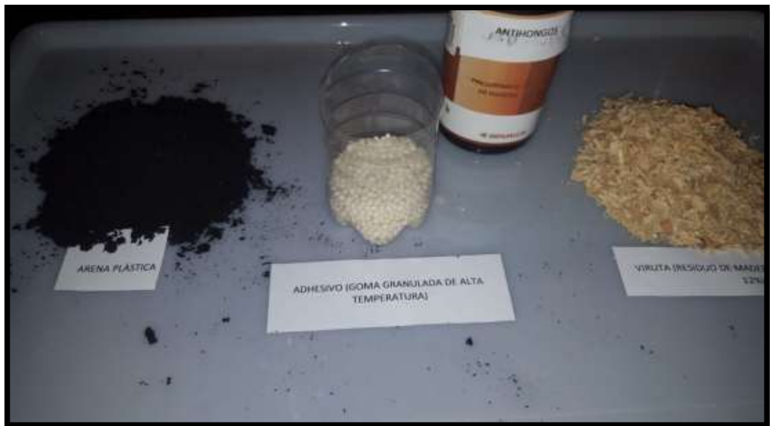
Figura 77. Materiales obtenidos para la fabricación de los paneles texturizados
