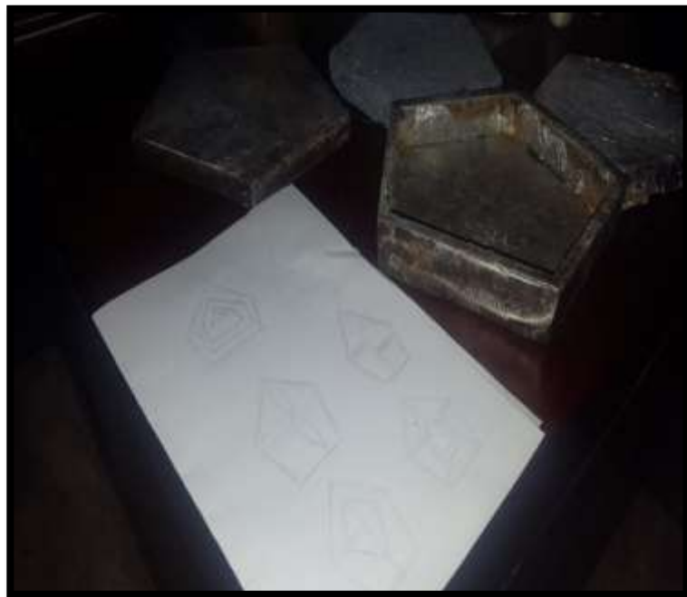
Figura 51. Bocetos y moldes para el proceso de fabricación del modelo del panel Fuente: Robinson Veliz, Zulay 2018 Elaboración: Robinson Veliz, Zulay
