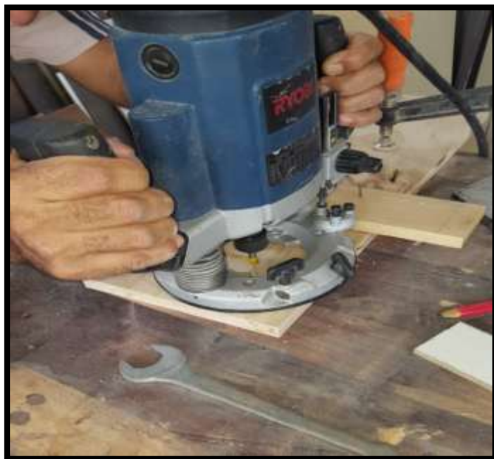
Figura 83. Proceso de tallado para luego sacar los moldes en hierro fundido
