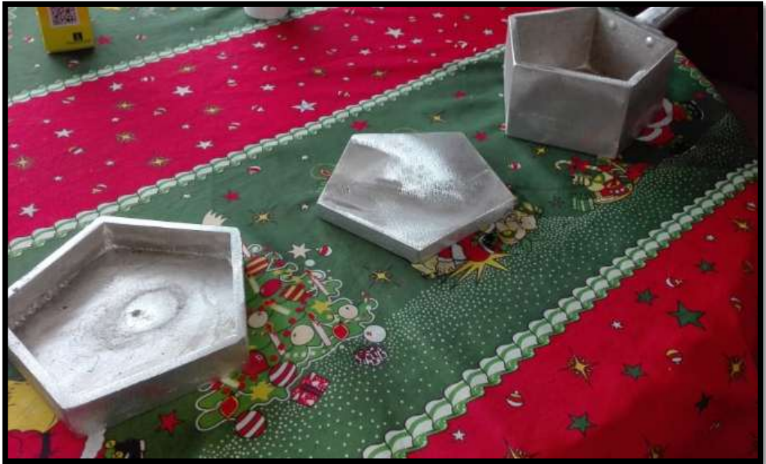
Figura 76. Moldes en hierro fundido para la fabricación de los paneles.
