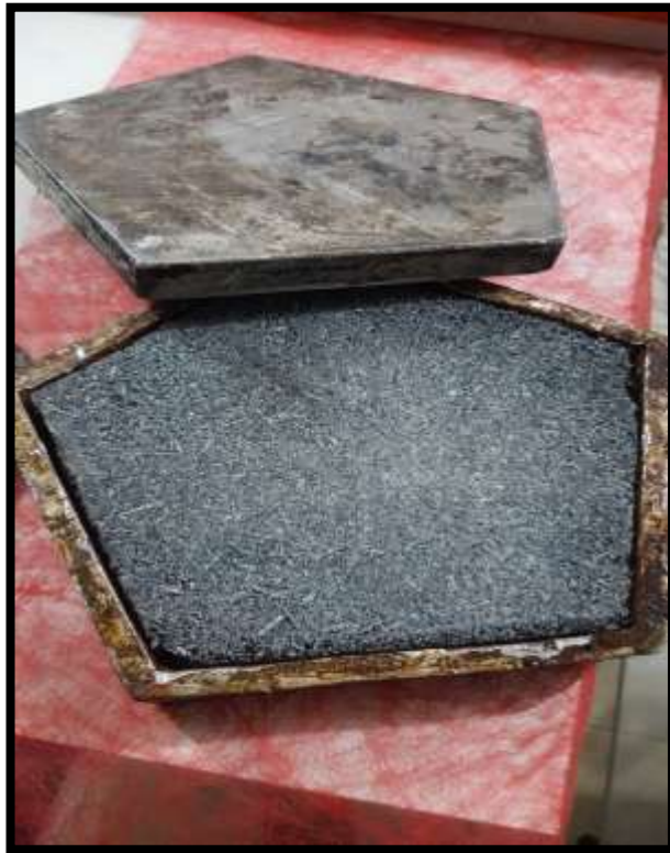
Figura 61. Proceso de fabricación del modelo del panel liso de manera casera
