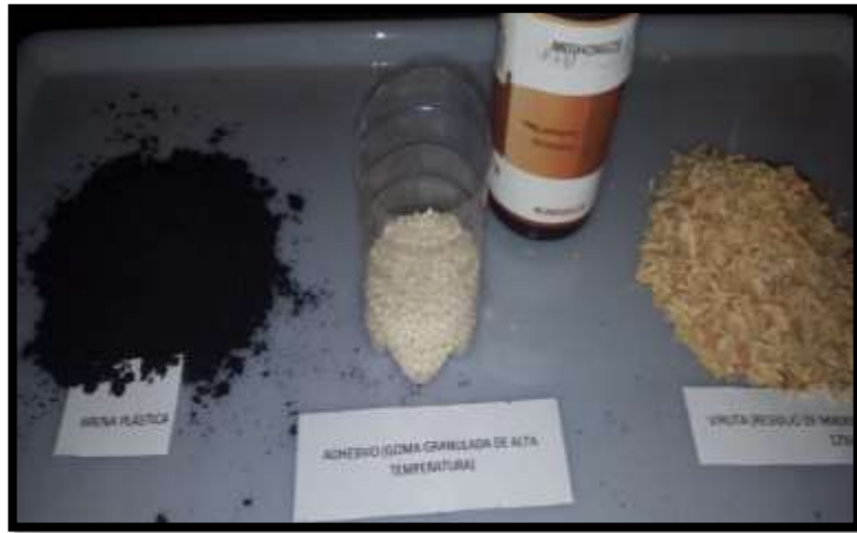
Figura 53. Materiales obtenidos para la fabricación de los paneles texturizados
