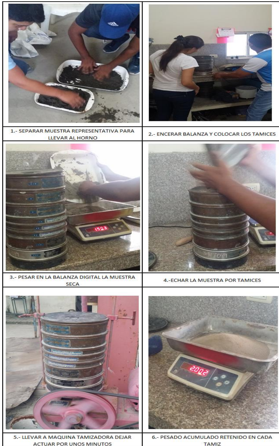
Figura N° 25 Ensayo Granulométrico
