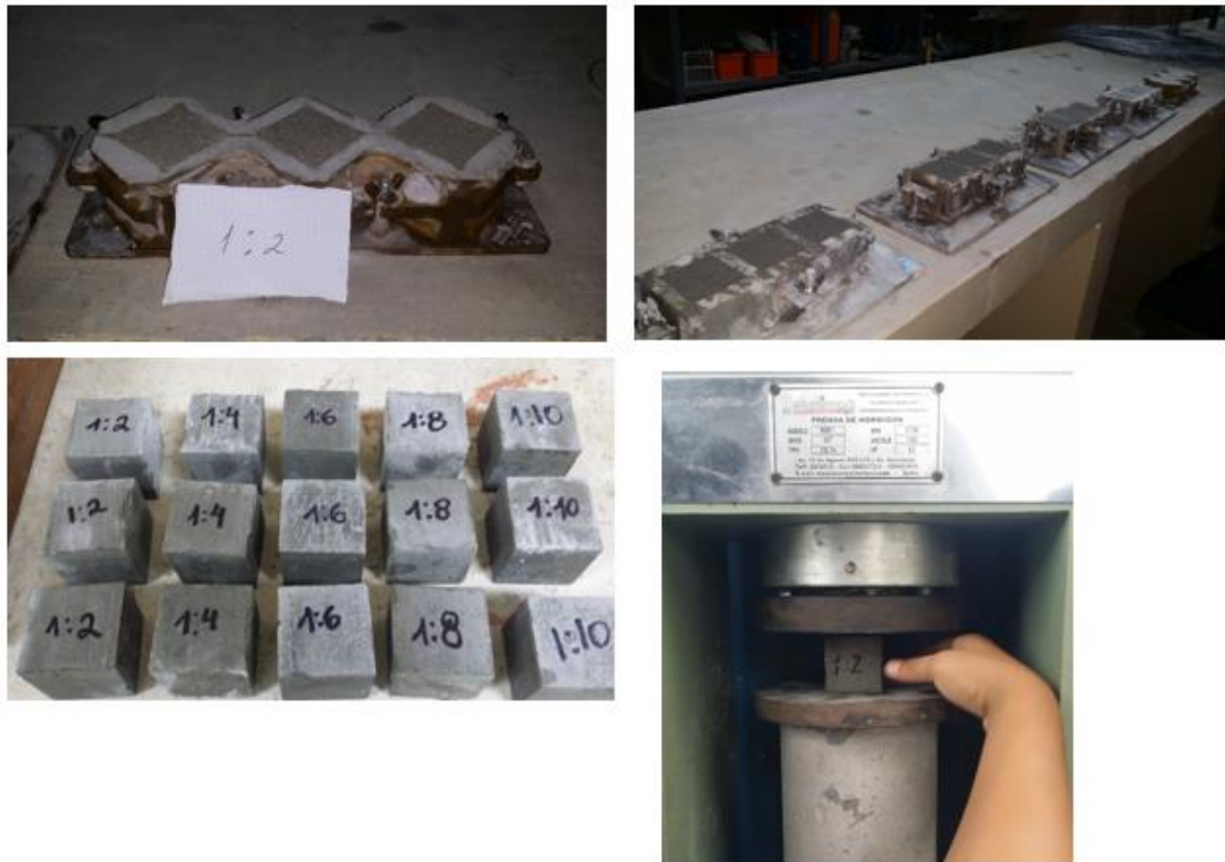
Figura N° 28 Toma de cubos de morteros - Rotura de Cubos
