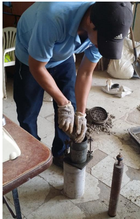
Figura N° 21 Agregado de material en capas
