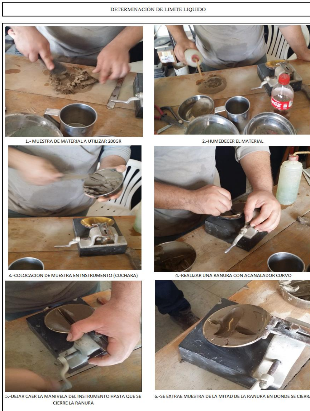
Figura N° 18 Ensayo de Plasticidad
