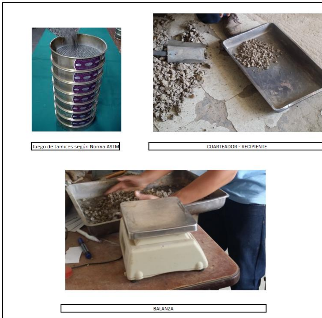
Figura N° 12 Instrumentos para Ensayo Granulométrico
