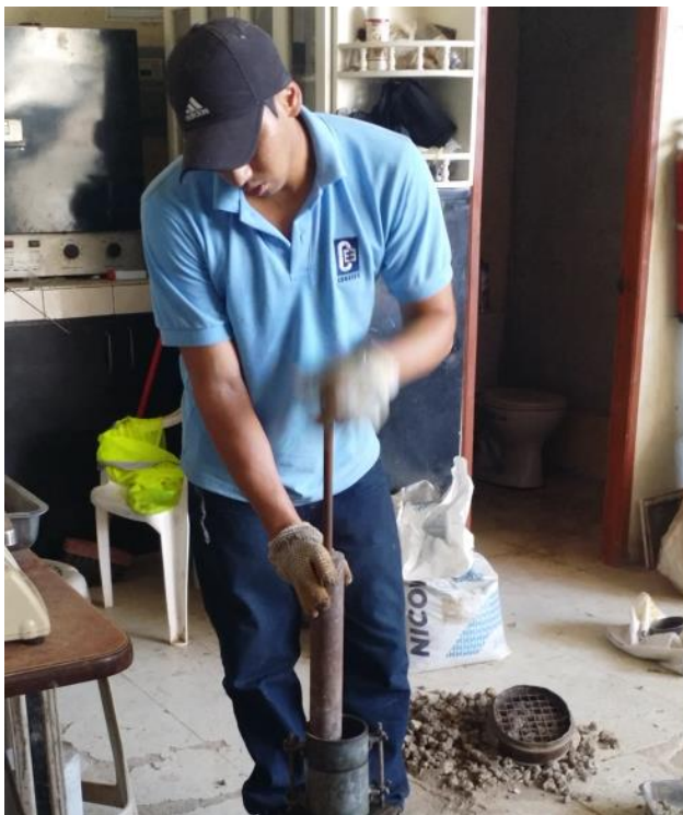
Figura N° 22 Compactación de material con pisón 2.5kg Fuente: (Propio)
