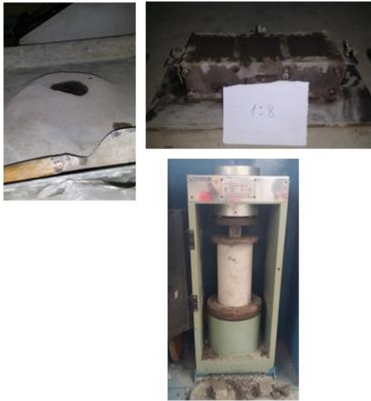
Figura N° 30 Rotura de Cilindros
