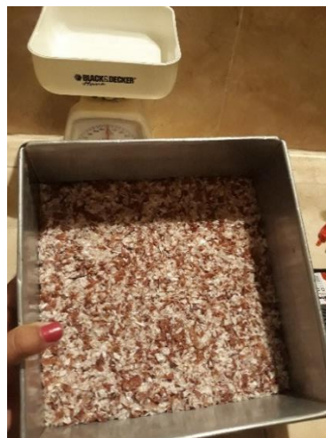
Ilustración 15 Mezcla colocada en el molde de metal 1. Elaborado por: Ingrid Machado.
