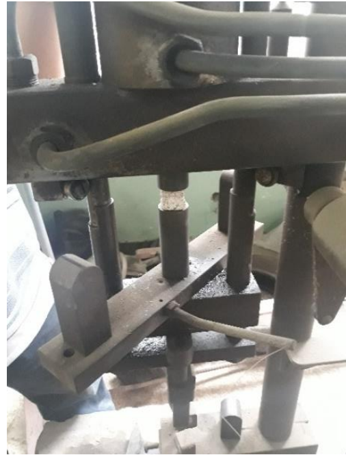
Ilustración 41 probeta colocada en máquina para ensayo de compresión. Elaborado por: Ingrid Machado.
