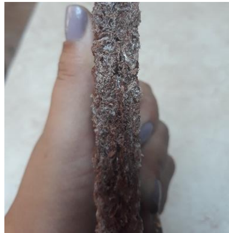
Ilustración 32 probeta para prueba de absorción de agua bordes 1 Elaborado por: Ingrid Machado.
