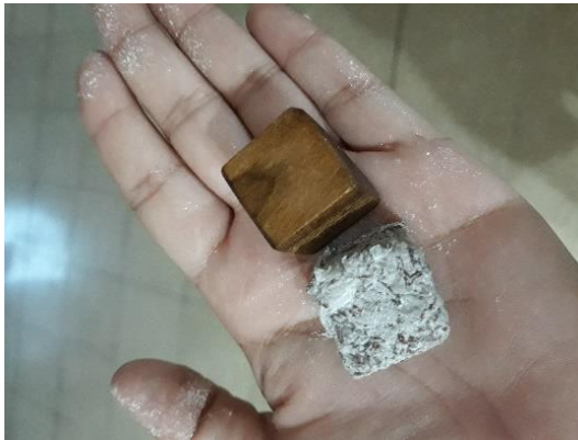
Ilustración 38 elaboración manual de probetas para ensayo de compresión Elaborado por: Ingrid Machado.
