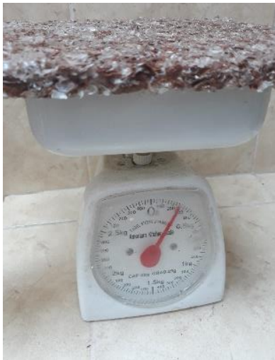
Ilustración 34 peso del tablero antes de ser sumergido Elaborado por: Ingrid Machado.
