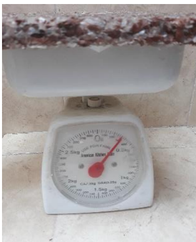
Ilustración 36 peso del tablero luego de ser sumergido 2hrs. Elaborado por: Ingrid Machado.
