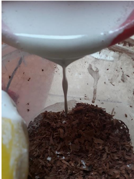
Ilustración 27 Mezcla de la viruta con la resina y el yeso. Elaborado por: Ingrid Machado.
