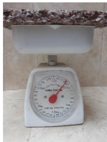
Ilustración 37 peso del tablero luego de ser sumergido 24hrs. Elaborado por: Ingrid Machado.
