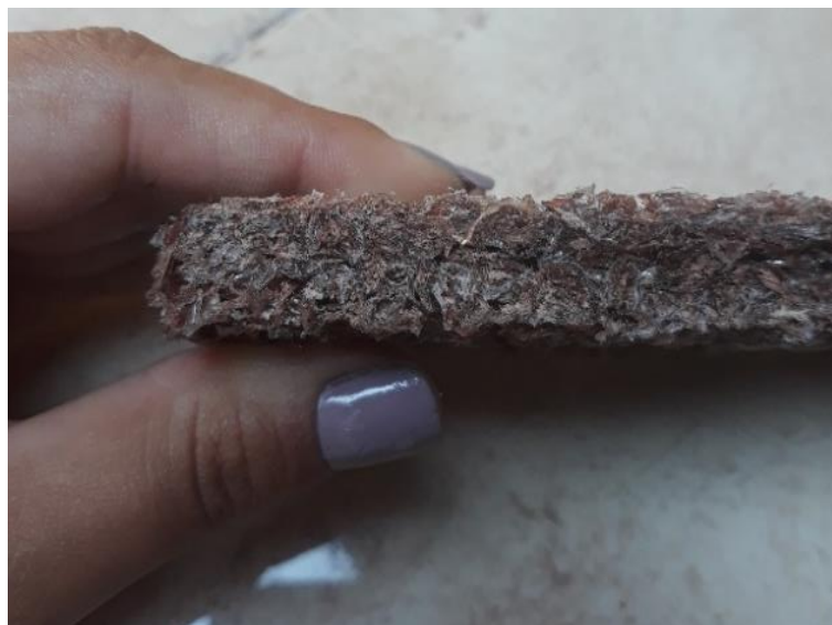
Ilustración 33 probeta para prueba de absorción de agua bordes 2. Elaborado por: Ingrid Machado.
