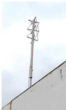
*Ilustración 13 Antena receptora de señales satelitales*
