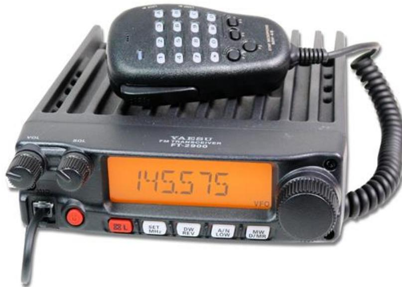
El docente deberá conectar el Radio a la fuente de alimentación de 13.8 volt., se establecerá la frecuencia en la que se realizaran las practicas, se podrá conectar a la antena de 147Mhz para conectarse a los satélites NOAA-19, NOAA- 15 y NOAA-18, de igual manera se podrá conectar con los módulos de radio frecuencia de los laboratorios Arduino.
