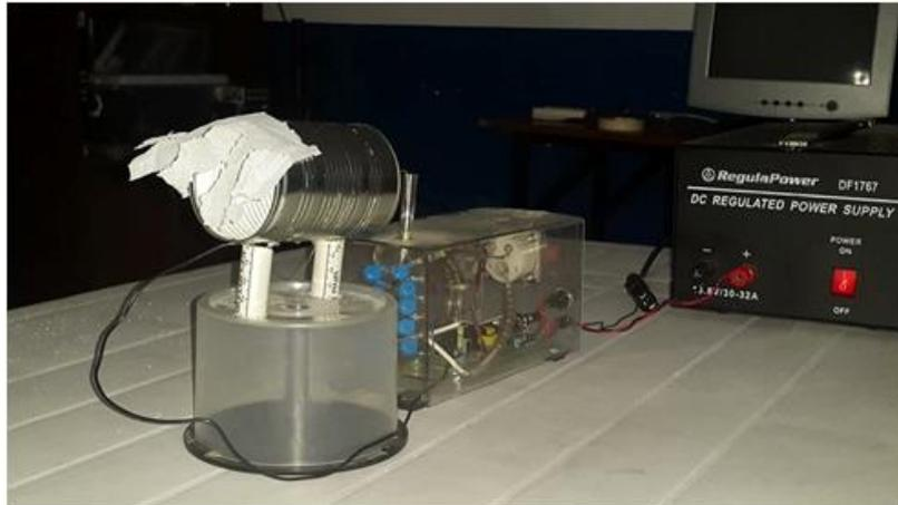
Uso exclusivo del docente, Equipo altamente peligroso, debe utilizarse en una área delimitada con perímetro de seguridad, este equipo se lo conecta a una toma polarizada y aterrizada, se conecta la fuente de alimentación a los polos positivo y negativo, debe utilizarse con guantes aislantes para alto voltaje, pues este equipo alcanza los 5000 Voltios.
