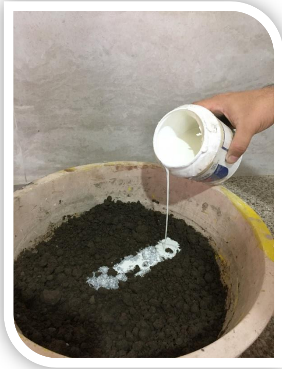
Fotografía 41. Aplicación de la Resina a la Argamasa.
