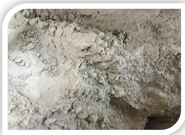
Fotografía 24. Uniformidad del Color Tierra- Cemento.
