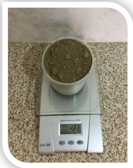
Fotografía 38. Pesaje de Cemento.
