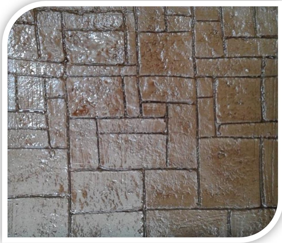
Fotografía 49. Piso Decorativo de Argamasa del Terreno y Cemento, Utilizando el Pigmento Mineral Desde el Inicio de la Conformación de la Argamasa. Fuente: Fotografía Tomada por Priscila Román, (2018)
