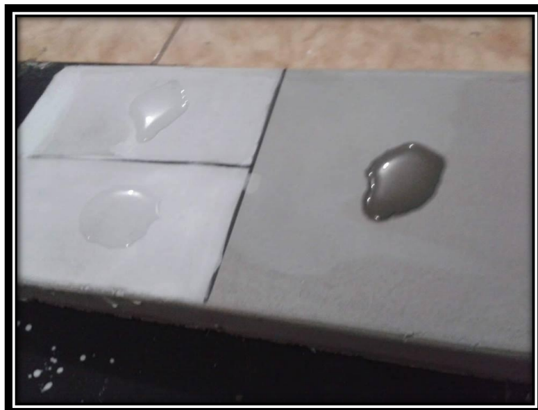
Ilustración 29. Resultado de impermeabilización de la segunda muestra Elaborado por: Guzmán Jiménez Andy; Hugo Ullauri Andrés
