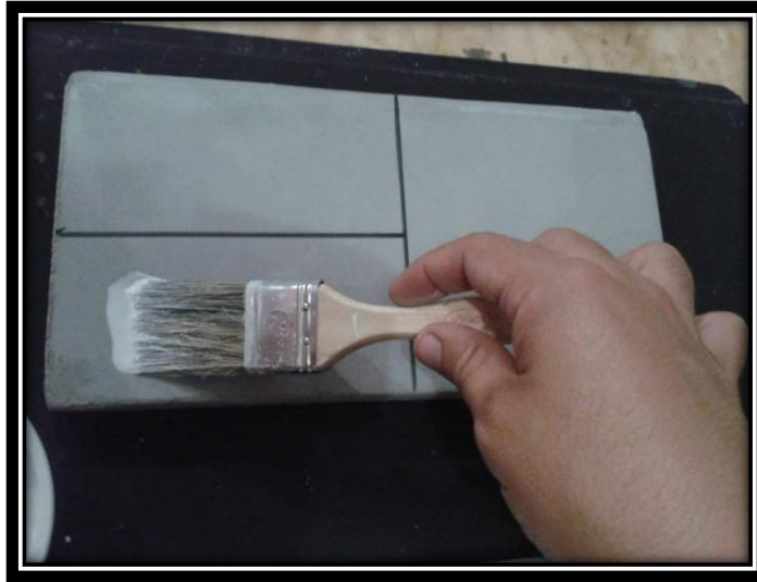
Ilustración 25. Aplicación de sellador en la muestra. Elaborado por: Guzmán Jiménez Andy; Hugo Ullauri Andrés
