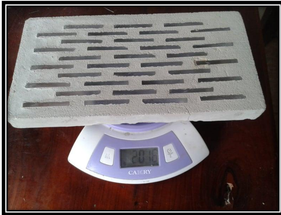
Ilustración 40. Bloque de concreto translucido con acrílico. Elaborado por: Guzmán Jiménez Andy; Hugo Ullauri Andrés
