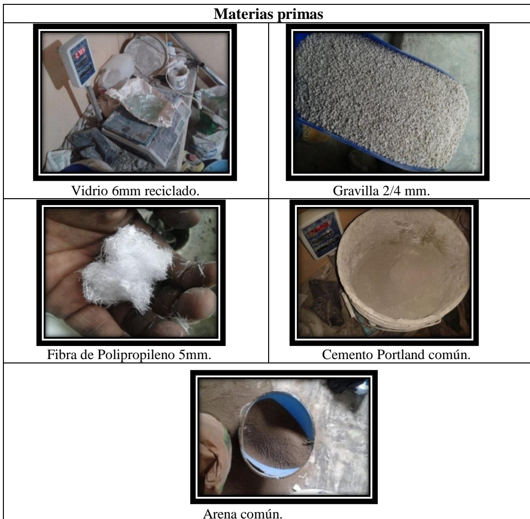
Ilustración 3. Materias primas para la elaboración del panel decorativo Elaborado por: Guzmán Jiménez Andy Javier, Hugo Ullauri Andrés Agustín
