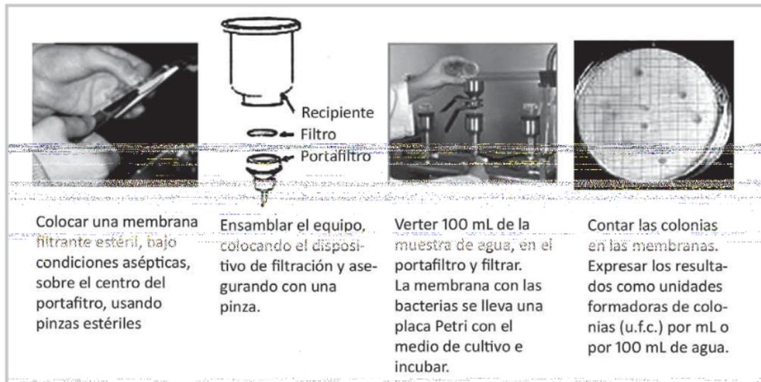
Figura 11. Técnica de la membrada filtrante para la determinación de bacterias.
