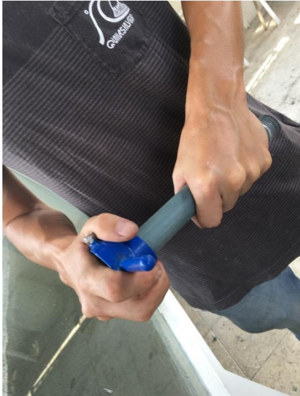
Figura 32. Elaboracion de rosca para tubería
