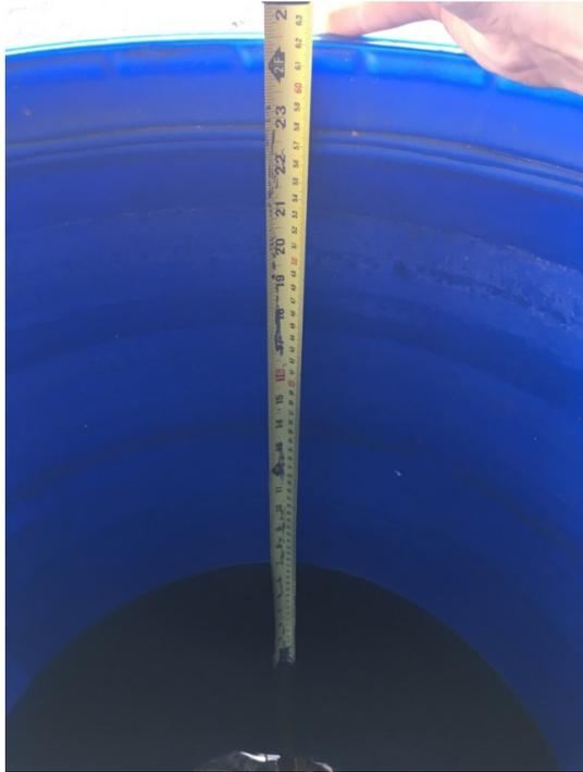
Figura 92. Altura de agua inicial de 62cm para ensayo#3
