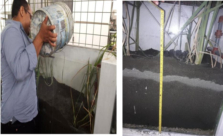
Figura 32. Capas de Arena gruesa en la Planta Piloto
