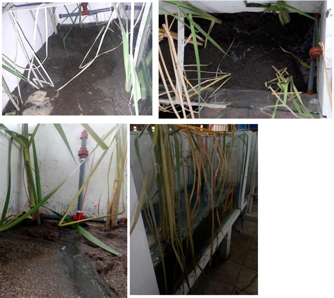
Figura 38. Recorrido del Agua Residual Atraves de las Capas de Filtración.
