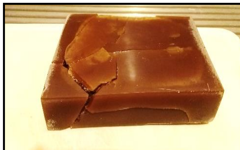
Figura 44. Verificación de prueba de calor a 200 grados Celsius Fuente: Navarrete Figueroa Carlos Juio
