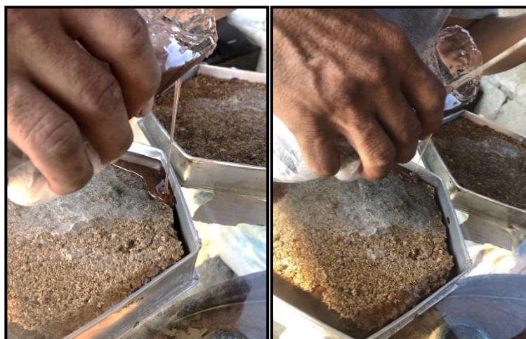
Figura 32. Aplicación de la resina de poliéster Fuente: Navarrete Figueroa Carlos Juio
