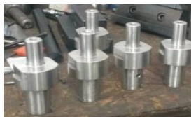
Figura 3: EJE GUÍA PARA BANDA BAADER (31,5 mm X 76 mm de longitud)
