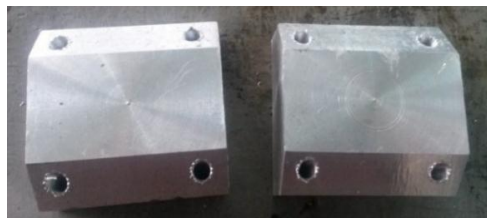
Figura 13: BASE PARA SOPORTE DE MARTILLO NEUMÁTICO (45 X45 X 25 mm de espesor)
