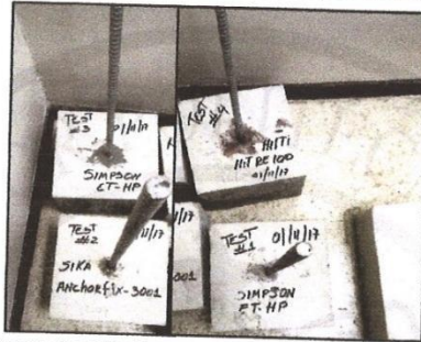
Fotografía 1. Muestras 17-1249, 17-1250, 17-1251 y 17-1252 previo al ensayo de tensión.
