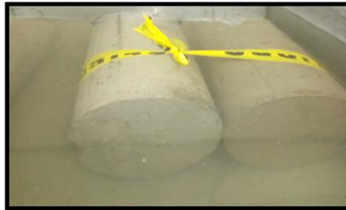
Imagen 52. Muestras cilíndricas para ensayos Fuente: Royy Briones 2018.
