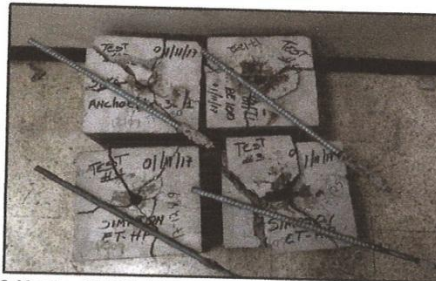
Fotografía 2. Muestras 17-1249, 17-1250, 17-1251 y 17-1252 luego del ensayo de tensión.
