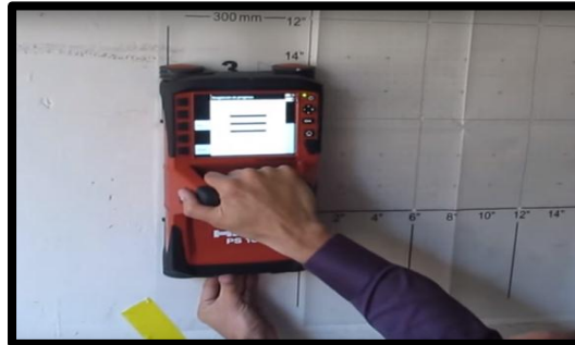
Imagen 54. Escáner para hormigón armado
