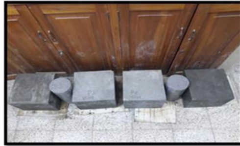
Imagen 50. Muestras de hormigón desencofrado. Fuente: Royy Briones 2018.
