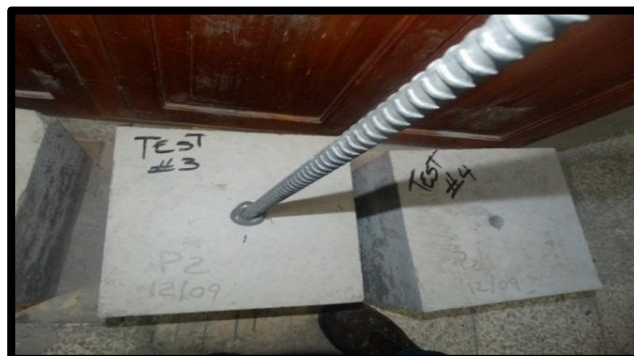
Imagen 59. Instalación de perno. Fuente: Royy Briones 2018.
