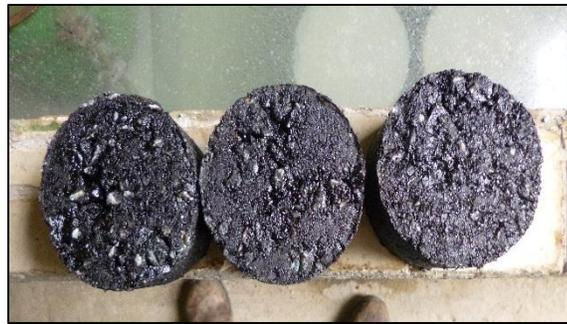
**Ilustración 6.** Briqueta de asfalto más 2% de plástico polietileno reciclado.
