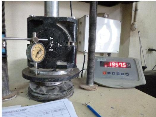
**Ilustración 8.** Briqueta con plástico colocada en la mordaza.
