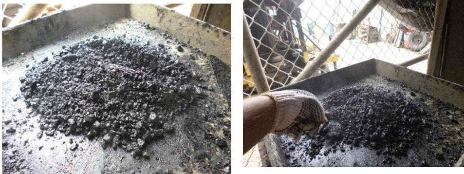
Ilustración 4. Mezcla asfáltica con adición de plástico.
