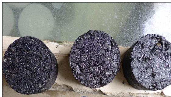
**Ilustración 7.** Briqueta de asfalto más 3% de plástico polietileno reciclado.
