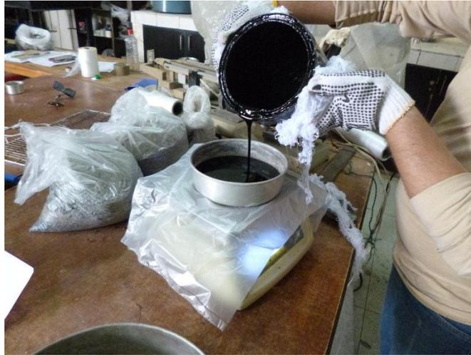
Ilustración 2. Calentamiento cemento asfáltico
