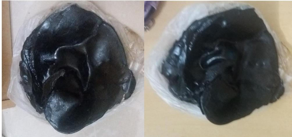
**Ilustración 9.** Mezcla asfalto-polietileno solidificada
