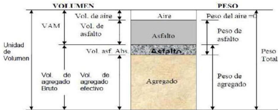
**Gráfico 1.** Representación de los Volúmenes en una Briqueleta Compactada de Mezcla Asfáltica
