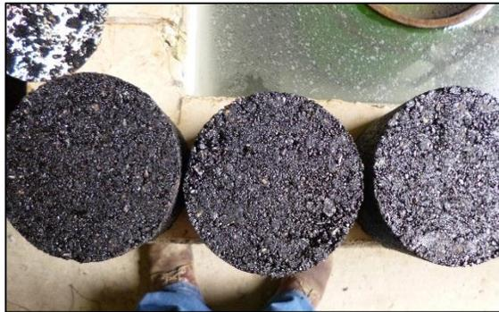
**Ilustración 5.** Briqueta de asfalto más 1% de plástico polietileno reciclado.
