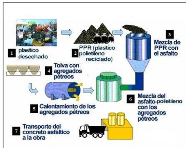
**Gráfico 3.** Esquema fabricación de las mezclas Asfalto-Polietileno - Vía Húmeda
