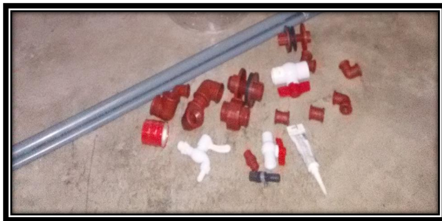
Foto 6. Accesorios de plomería del reactor aeróbico secuencial.
