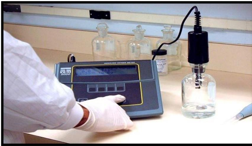
**Figura No. 17** Analizador de DBO.
