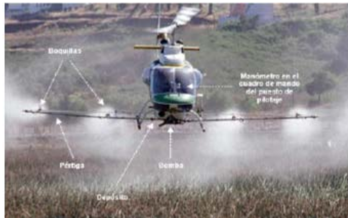
Gráfico 4: Elemento de un pulverizador aerotransportado sobre un helicóptero
