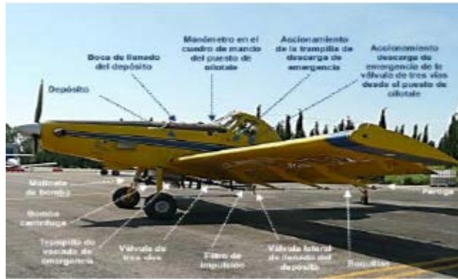
Gráfico 3: Elementos de un pulverizador aerotransportado por una avioneta
