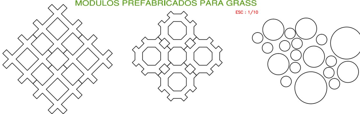
**MODULOS PREFABRICADOS DE CONCRETO**
