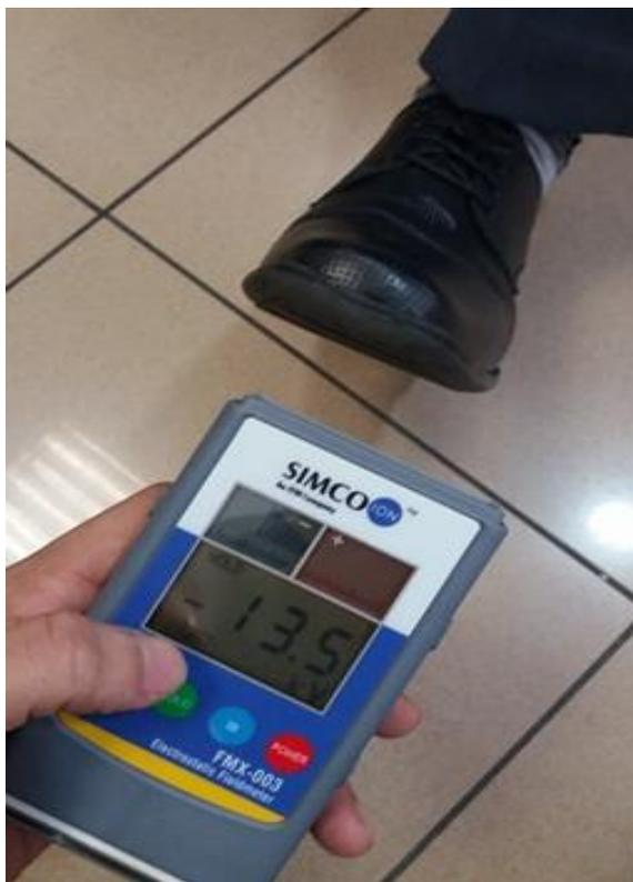
Foto 3. Toma de Datos con el Medidor de Estática (SIMCO FMX-003).
