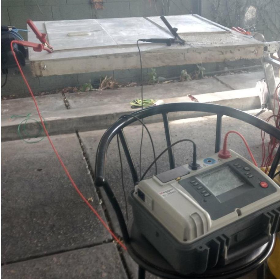
*Foto 4.* Conexión del equipo Megger desde Punto de Baldosa a Puesta a Tierra.
