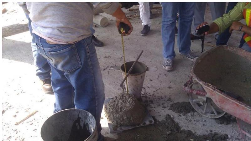
*Foto 16.* Ensayo de Asentamiento por medio del Cono de Abrams.
