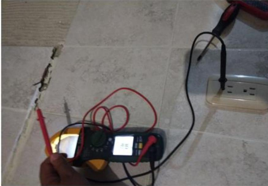
*Foto 7.* Medición de Continuidad entre el Perfil y la Puesta a Tierra del Sistema Eléctrico.
