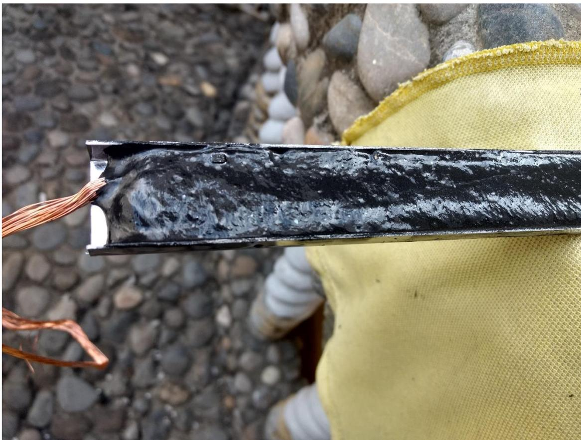
*Foto 22.* Relleno del Canal Interior del Perfil con Pasta de Grafito en Polvo y Agua.
