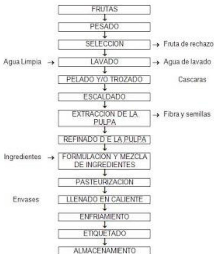
**Figura 15.** Diagrama de Flujo del Proceso para jugo de pulpa de fruta
