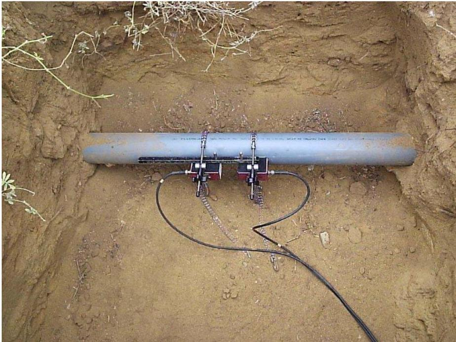
**Figura 7. Instalación del sensor para el caudalímetro portátil ultrasónico SIEMENS.**
