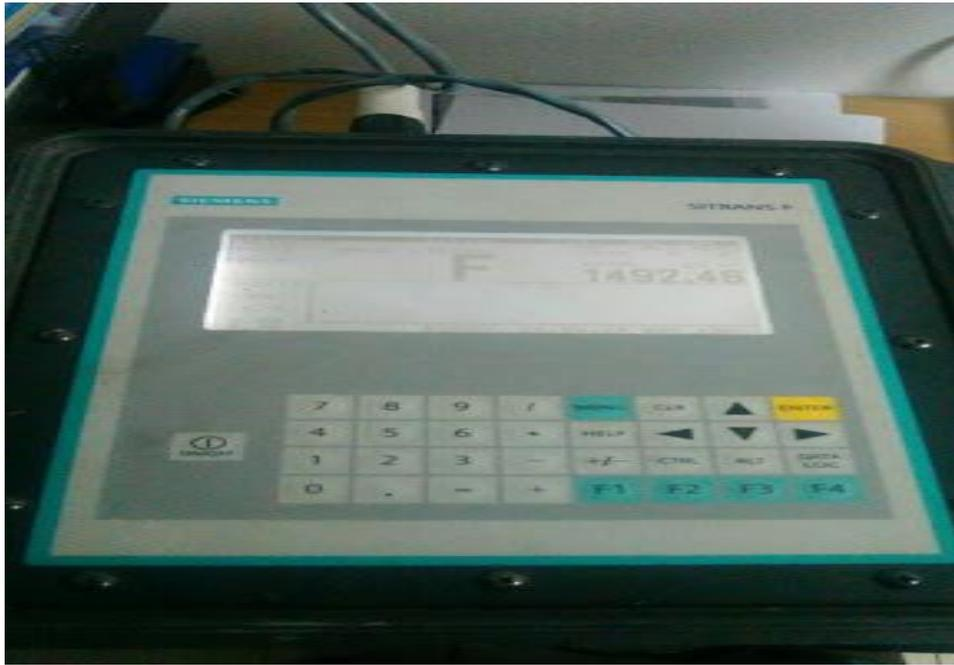
**Figura 11. Caudalímetro Portátil SIEMENS en proceso de medición.
