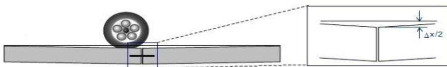
Figura d.2. Junta 100% efectiva. La carga la soportan entre las dos losas.
