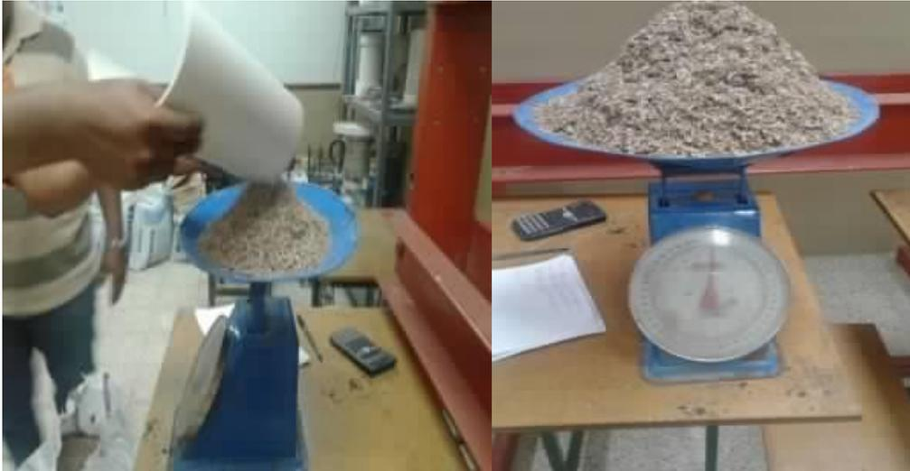
**Figura 24.** Mezclado de los materiales para la elaboración de bloques. Foto tomada de: Castillo Washington y Lindao Rolando
