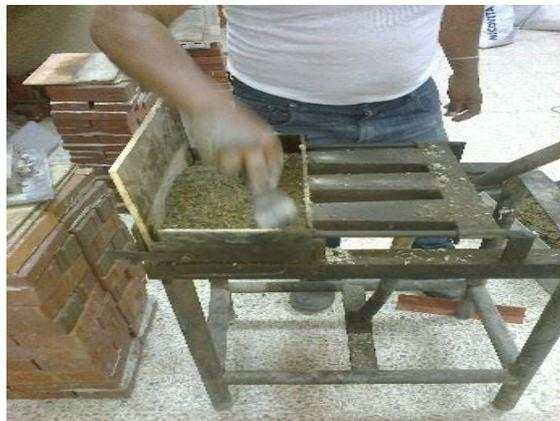
**Figura 22.** Homogenización de los materiales secos con el agua para la elaboración de bloques. Foto tomada de: Castillo Washington y Lindao Rolando
