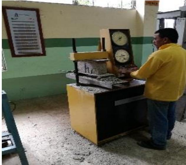
**Figura 29.** Visualización del proceso de rotura del bloque elaborado con cascara de arroz. Foto tomada por: Castillo Washington y Lindao Rolando.
