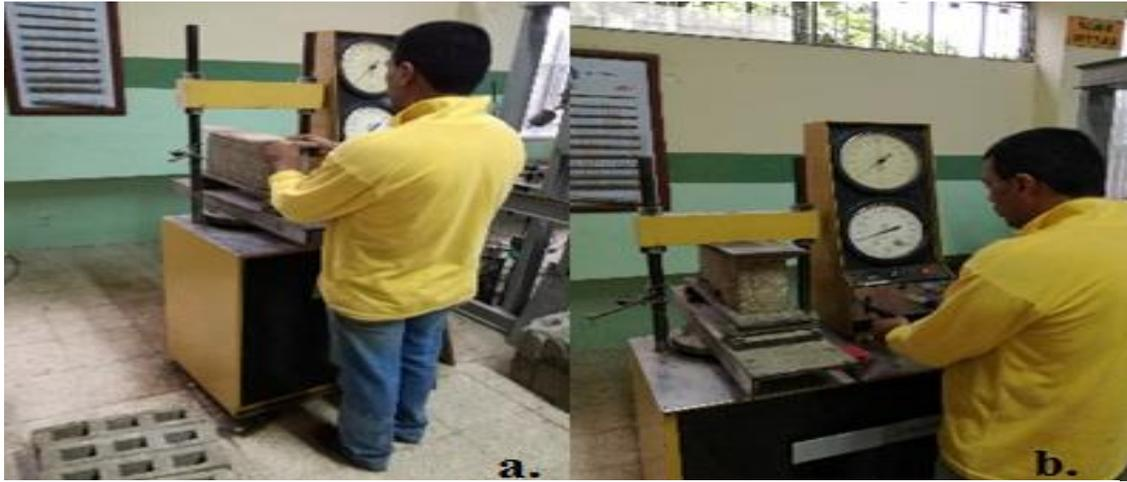
**Figura 26. a.** Colocación del bloque hecho a base de cascara de arroz en la maquina universal para carga. **b.** Valoración de la fuerza de rotura del primer ensayo. Foto tomada por: Castillo Washington y Lindao Rolando.
