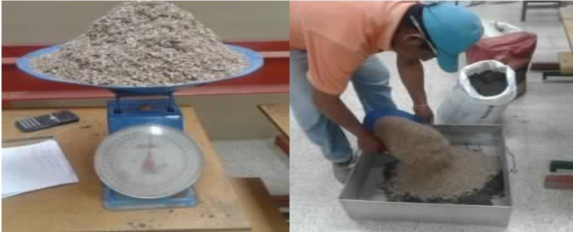
**Figura 17.** Pesaje de la arena según las proporciones indicadas anteriormente, utilizada para la elaboración de bloques. Foto tomada por: Castillo Washington y Lindao Rolando
