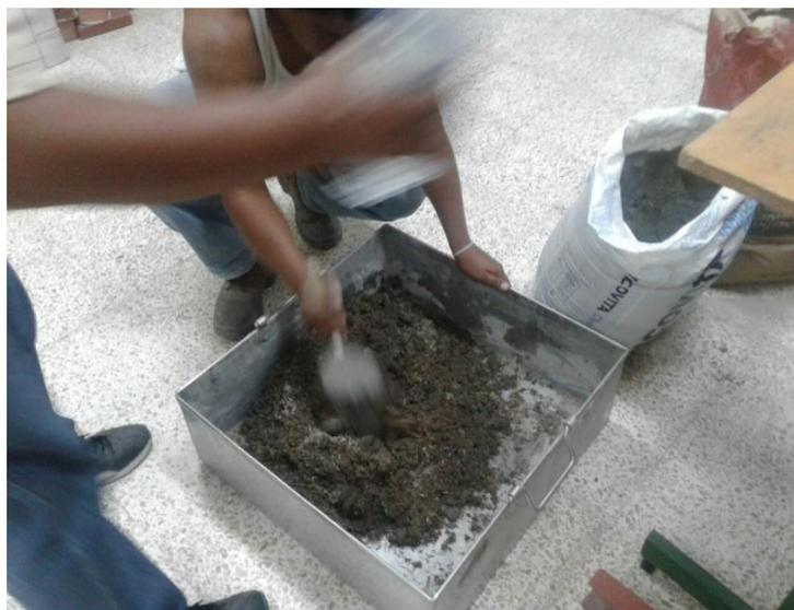
**Figura 14.** Mezclado de la cascara de arroz y arena. Foto tomada por: Castillo Washington y Lindao Rolando
