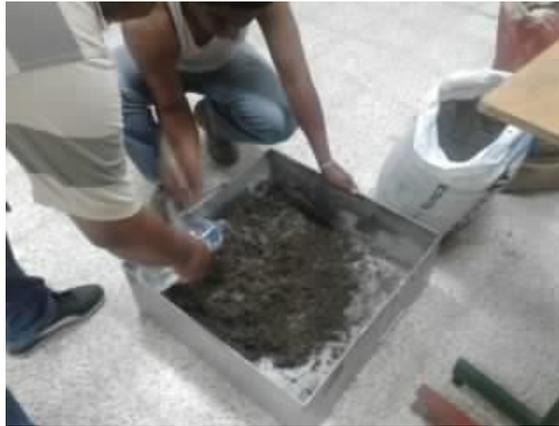
**Figura 19.** Mezcla del agua con los materiales secos. Foto tomada por: Castillo Washington y Lindao Rolando
