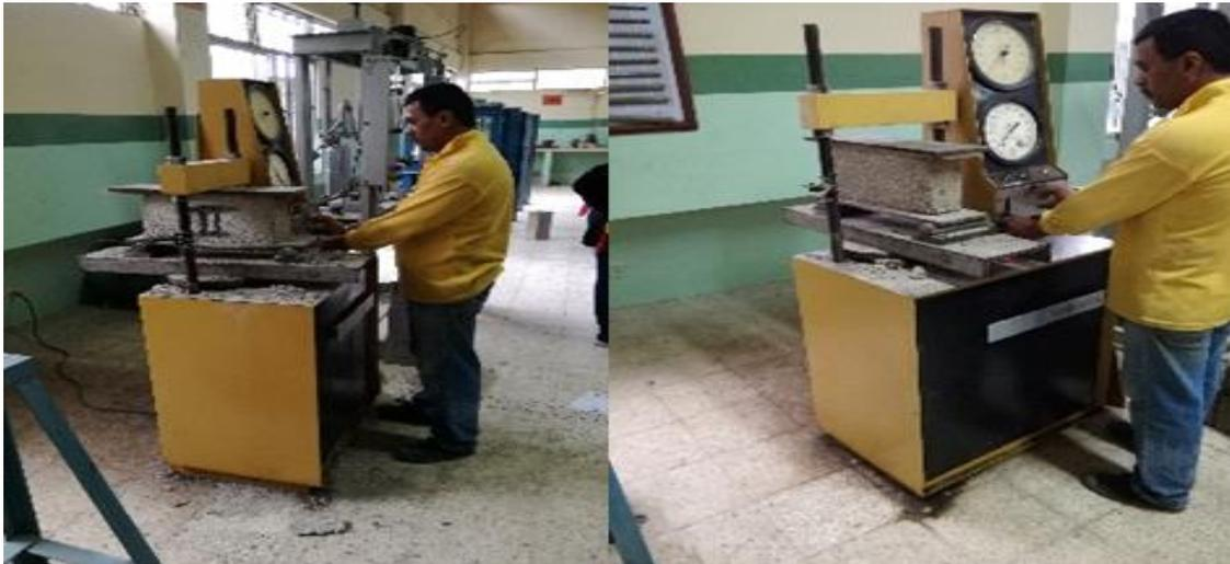
**Figura 27.** Valoración de la fuerza de rotura de los bloques hecho a base de la cascara de arroz, en el segundo ensayo. Foto tomada por: Castillo Washington y Lindao Rolando.
