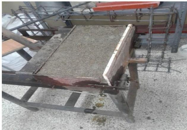
**Figura 15.** Maquina bloquera. Foto tomada por: Castillo Washington y Lindao Rolando
