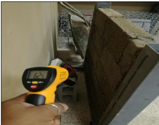
**Figura 13.** Toma de temperatura a través de medidor laser. Foto tomada por: Castillo Washington y Lindao Rolando
