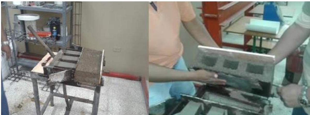
**Figura 20.** Moldeado de bloque. Foto tomada por: Castillo Washington y Lindao Rolando
