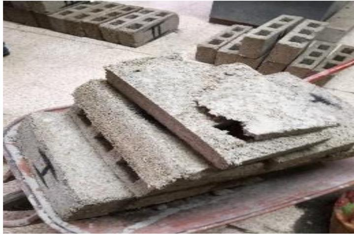
**Figura 16.** Estructura de bloques hechos a base de cascara de arroz. Foto tomada por: Castillo Washington y Lindao Rolando
