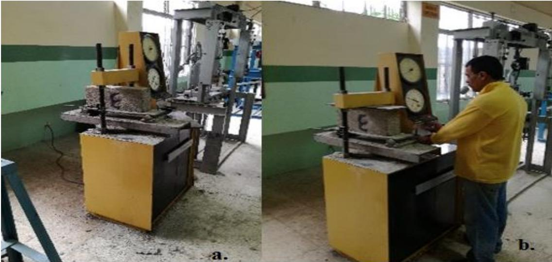
**Figura 28.** a. Maquina universal de carga. b. Visualización y valoración de la fuerza de rotura de los bloques hecho a base de cascara de arroz. Foto tomada por: Castillo Washington y Lindao Rolando.
