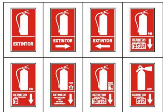
FIGURA 5 – Carteles varios con las señales para indicar la ubicación del extintor
