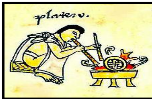
Fundidor avivando el fuego mientras retira impurezas con un escoriador
