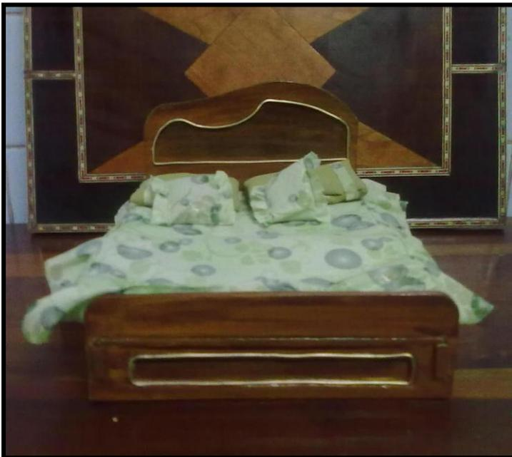
Mobiliario hecho con tableros MDF. Está formado por cinco piezas desmontables con juntas de espiga y mortaja con la utilización de clavijas. El diseño de sus ensambles esta dado para su resistencia y para dar un mayor soporte.
