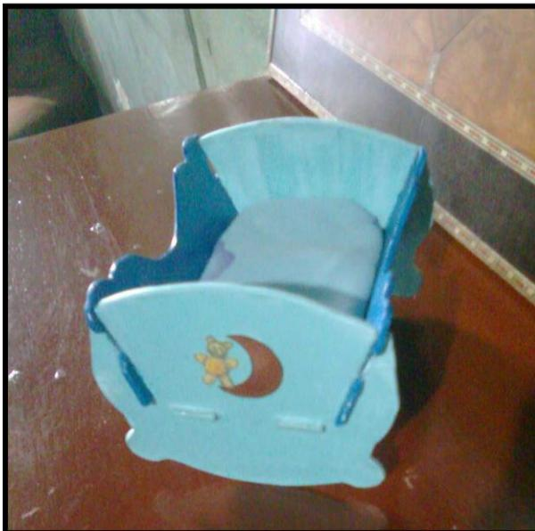
Cuna hecha con tableros de plywood corriente. Está formada por cinco piezas desmontables, con cortes de ranura y lengüeta y juntas de espiga y mortaja, además de la utilización de clavijas para dar un buen soporte y resistencia.
