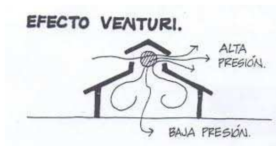
Figura # 55. Efecto de Venturi.
