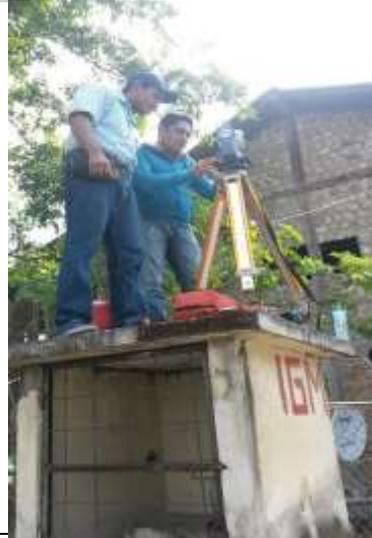
Se observa la medición con estación total para obtener coordenadas del sector.
