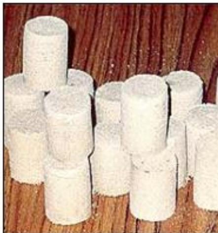
*Figura 2* Briqueta de cascarilla de arroz
