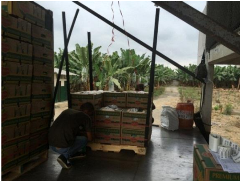
Ilustración 18. Personal asegurando los sunchos y esquineros con el uso de grapas
