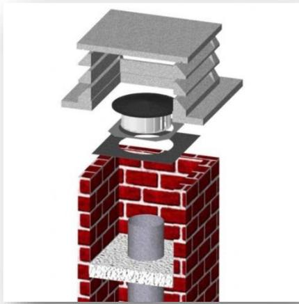
Colocación: Primero se realiza un agujero circular de diámetro 20cm en la cubierta de los nichos. Alrededor del mismo, se sitúa la base del aspirador, es conveniente fijarla con una resina e impermeabilizar la junta inferior. También se encaja dentro de la base el filtro de carbón activo, este apoya en la cubierta sobre el perímetro del agujero. Posteriormente se van montando los 4 anillos y el sombrerete o tape del aspirador.
