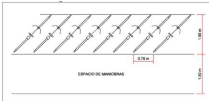
Otro tipo de estacionamiento horizontal está constituido por estructuras que permiten sujetar la bicicleta, mediante candados o cadenas de propiedad del ciclista; ofreciendo estabilidad y seguridad para estacionamientos de larga duración.
