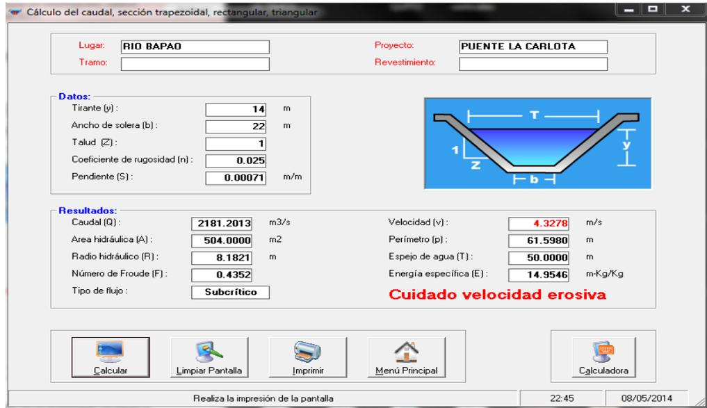
**Figura 34. Datos hidráulicos de sección típica (promedio) del río Congo en la actualidad (al pasar a través del puente La Carlota).**
